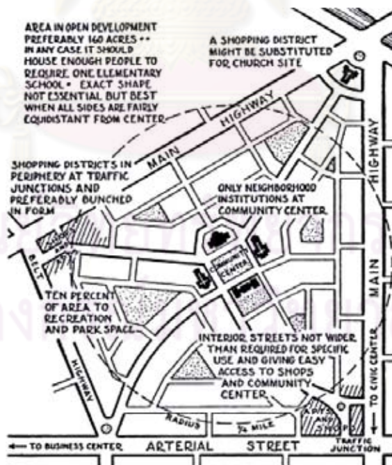
ภาพ 2.7 แนวความคิดชุมชนละแวกบ้าน ซึ่ง Clarence Perry
