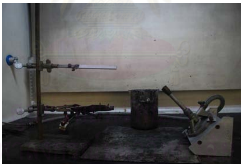
รูปที่ 3.11 ลักษณะการจัดวางอุปกรณ์ในการทดสอบการติดไฟในแนวนอนตามมาตรฐาน UL-94 แบบ HB
