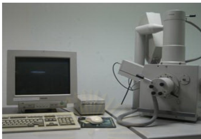
รูปที่ 3.4 กล้องจุลทรรศน์อิเล็กตรอนแบบส่องกราด
