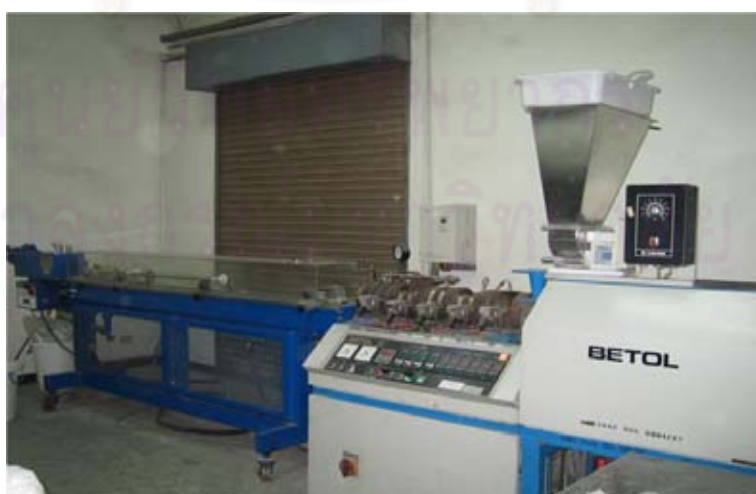
รูปที่ 3.2 เครื่องอัดรีดพลาสติกแบบหลอมเหลวชนิดเกลียวคู่
