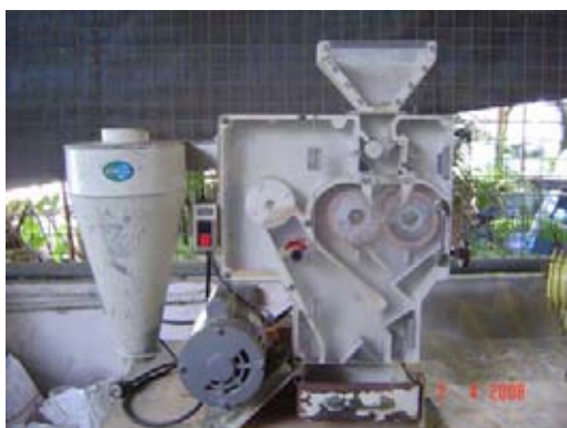
รูปที่ ก.5 เครื่องกะเทาะเปลือกชนิดลูกกลิ้งยาง
