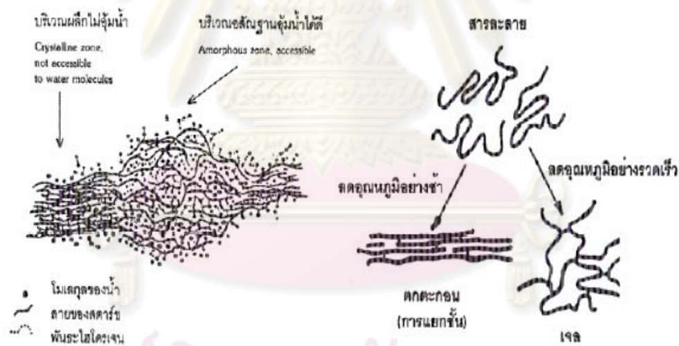
รูปที่ 2.10 กลไกการรีโทรเกรเดชันของสตาร์ช
