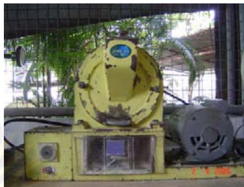
รูปที่ ก.6 เครื่องขัดขาวชนิดหินขัด
