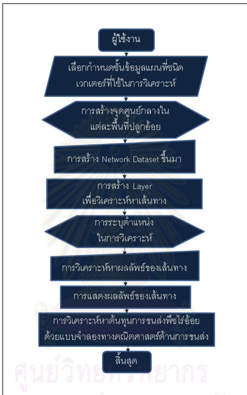
รูปที่ 3.10 แสดงแผนผังขั้นตอนการทำงานของโปรแกรมการวิเคราะห์หาเส้นทาง และต้นทุนการขนส่งพืชไร่อ้อย
