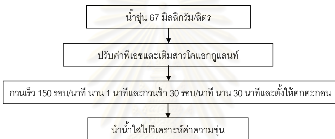
รูปที่ 3.6 แผนผังการหาปริมาณโคแอกกูแลนต์ที่เหมาะสมในการทำลายเสถียรภาพน้ำชุ่ม
