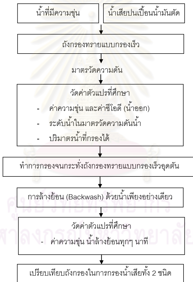
รูปที่ 3.5 แผนผังการทำงานของถังกรองทรายแบบกรองเร็ว
