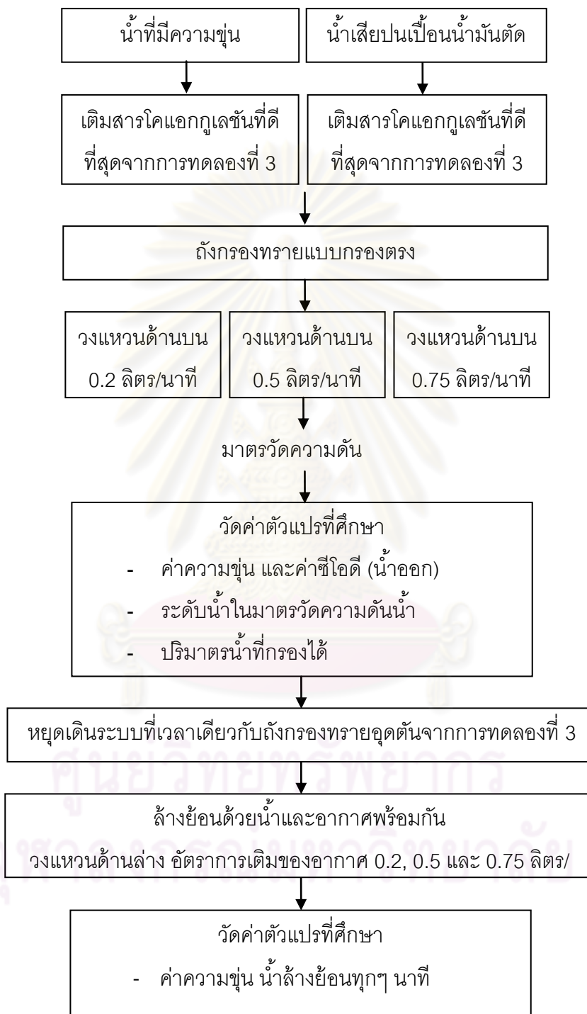
รูปที่ 3.9 แผนผังการทำงานของถึงกรองทรายโดยการประยุกต์ใช้การเติมอากาศ
