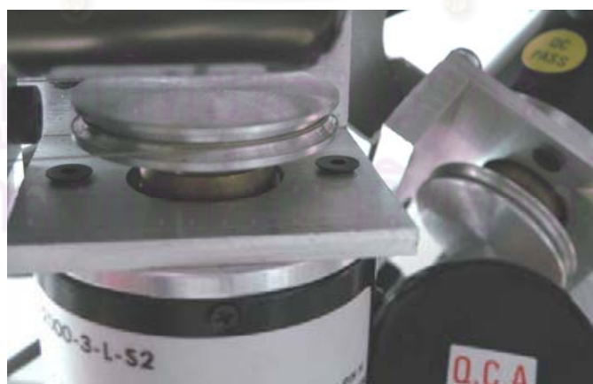
รูปที่ ก.7 ระบบมู่เล่สายพานของอุปกรณ์วัดมุมของข้อต่อแบบเลื่อน
