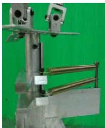
รูปที่ 7.4 กลไกสำหรับตำแหน่งเริ่มต้นลือคปลายแขนแฮบติค
