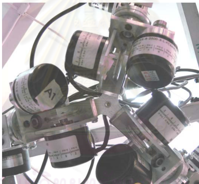
รูปที่ ก.4 ตำแหน่งที่ติดตั้งอุปกรณ์วัดมุมของข้อแบบเลื่อน
