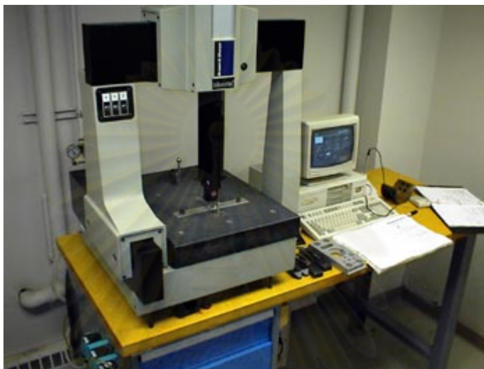
รูปที่ 3.4 แสดงเครื่องวัดพิกัดแบบ 3 แกน ของบริษัท Brown&Sharpe
