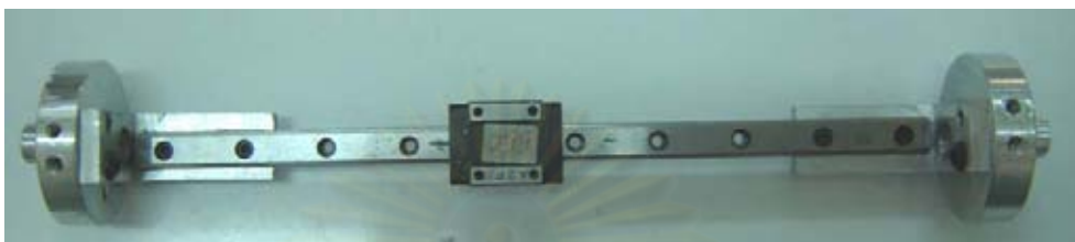
รูปที่ 6.1 ข้อต่อแบบเลื่อนก่อนการปรับปรุง
