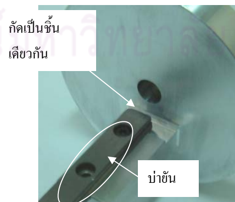
รูปที่ 6.7 พูเลย์ที่ยึดติดกับลิเนียร์สไลด์หลังปรับปรุง
