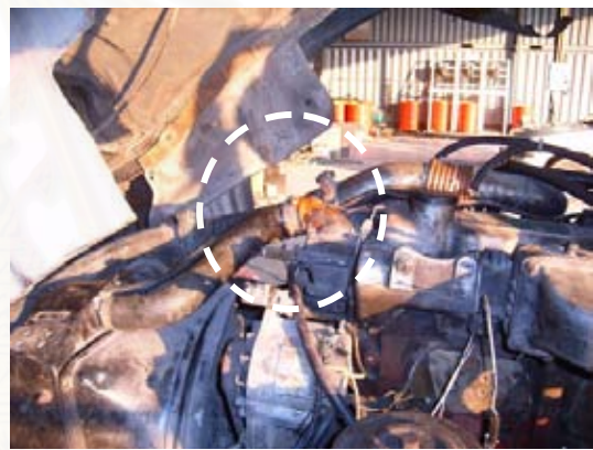
รูปที่ 4-44 ตำแหน่งการวัดอุณหภูมิ ที่ทางน้ำเข้าและน้ำออกจากเครื่องยนต์
