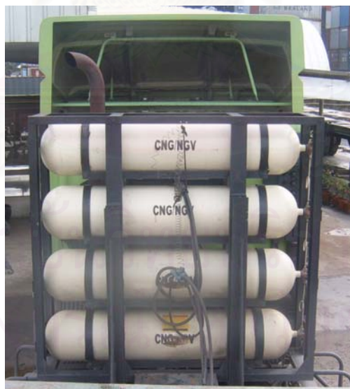
รูปที่ 4-47 แสดงภาพถังก๊าซธรรมชาติที่ติดตั้งในรถหัวลาก Hino รุ่น FM2PKPA
