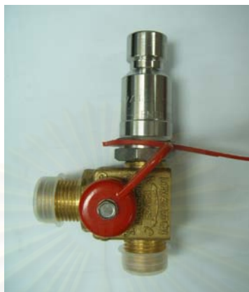
รูปที่ 4-8 แสดงภาพหัวรับเติมก๊าซธรรมชาติที่ติดตั้งในรถตู้
