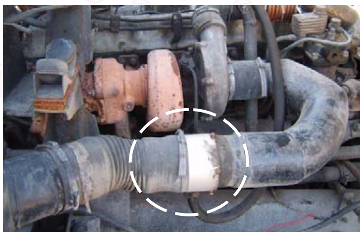
รูปที่ 4-39 แสดงภาพอุปกรณ์ผสมก๊าซกับอากาศที่ติดตั้งในรถหัวลาก Hino รุ่น ZM500
