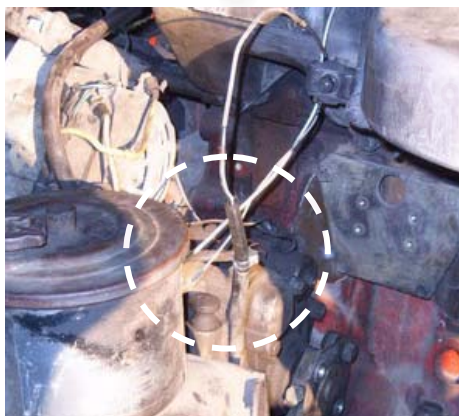
รูปที่ 4-45 ตำแหน่งการวัดอุณหภูมิน้ำมันหล่อลื่นและอุณหภูมิบรรยากาศบริเวณช่องรับลมด้านหน้ารถ
