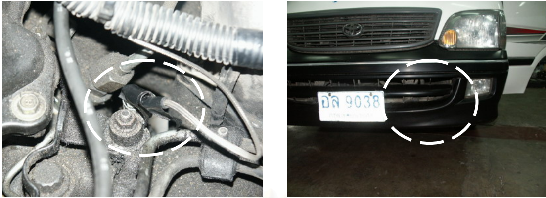
รูปที่ 4-16 ตำแหน่งการวัดอุณหภูมิน้ำมันหล่อลื่นและอุณหภูมิบรรยากาศ บริเวณช่องรับลมของกันชนหน้า
