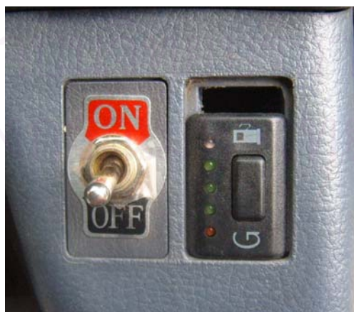
รูปที่ 4-52 แสดงภาพสวิตช์ควบคุมการใช้ก๊าซธรรมชาติที่ติดตั้งในรถหัวลาก Hino รุ่น FM2PKPA
