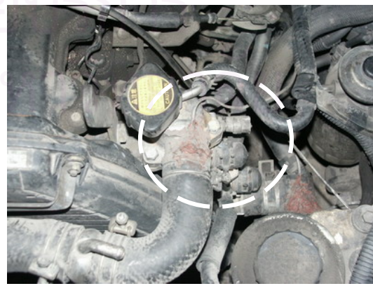
รูปที่ 4-15 ตำแหน่งการวัดอุณหภูมิ ที่ทางน้ำเข้าและน้ำออกจากเครื่องยนต์
