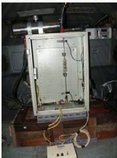
รูปที่ 4-22 แสดงอุปกรณ์วัดอัตราการสิ้นเปลืองน้ำมันเชื้อเพลิงที่ติดตั้งเพิ่มเติมในรถยนต์ทดสอบ
