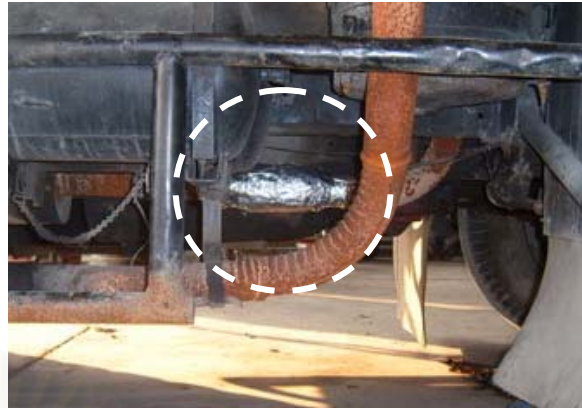
รูปที่ 4-43 ตำแหน่งการวัดอุณหภูมิอากาศเข้าที่ท่อไอดีและไอเสียบริเวณผิวท่อไอเสีย
