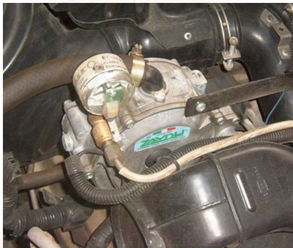
รูปที่ 4-31 แสดงภาพอุปกรณ์ปรับลดความดันก๊าซธรรมชาติที่ติดตั้งในรถกระบะ
