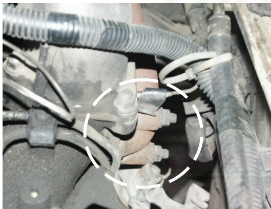
รูปที่ 4-14 ตำแหน่งการวัดอุณหภูมิอากาศเข้าที่ท่อไอดีและไอเสียบริเวณผิวท่อไอเสีย
