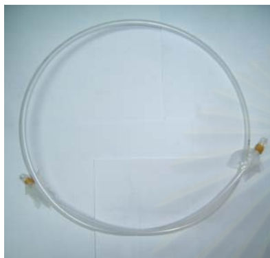
(ก) ท่อสำหรับสุ่มน้ำมันหล่อลื่น
