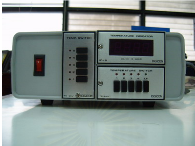
รูปที่ 4-13 แสดงภาพตัวอ่านค่าอุณหภูมิ และชุดเพิ่มตำแหน่งการอ่านค่าอุณหภูมิ
