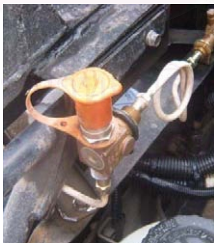
รูปที่ 4-54 แสดงภาพหัวรับเติมก๊าซธรรมชาติที่ติดตั้งในรถหัวลาก Hino รุ่น FM2PKPA
