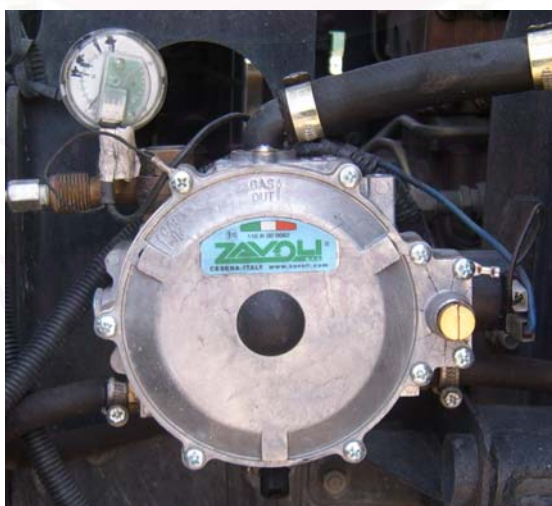
รูปที่ 4-50 แสดงภาพอุปกรณ์ปรับลดความดันก๊าซธรรมชาติที่ติดตั้งในรถหัวลาก Hino รุ่น FM2PKPA
