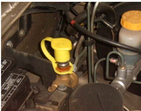
รูปที่ 4-34 แสดงภาพหัวรับเติมก๊าซธรรมชาติที่ติดตั้งในรถกระบะ
