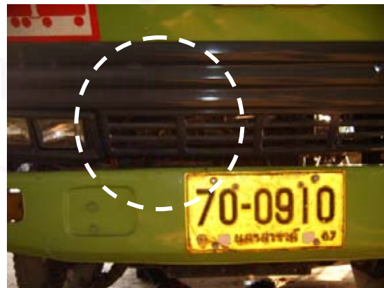
รูปที่ 4-45 ตำแหน่งการวัดอุณหภูมิน้ำมันหล่อลื่นและอุณหภูมิบรรยากาศบริเวณช่องรับลมด้านหน้ารถ
