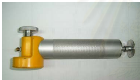
(ค) ครอบกบ็้ม ภายในมีลูกสูบสำหรับสุ่มน้ำมันหล่อลื่น
