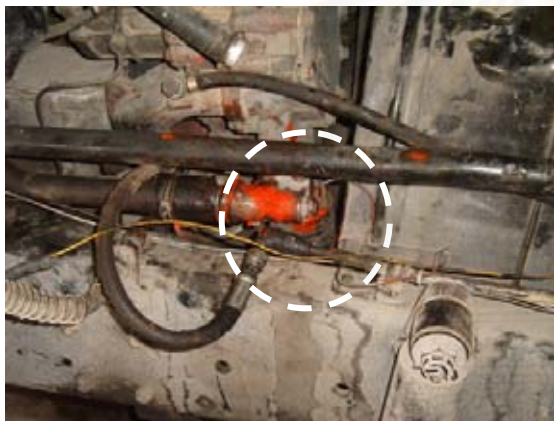
รูปที่ 4-44 ตำแหน่งการวัดอุณหภูมิ ที่ทางน้ำเข้าและน้ำออกจากเครื่องยนต์
