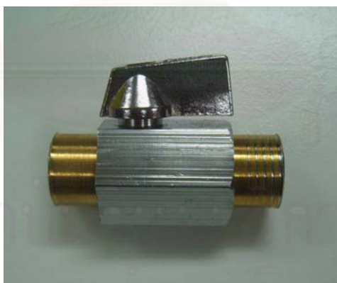
รูปที่ 4-9 แสดงภาพบอลวาล์วที่ติดตั้งในรถตู้
