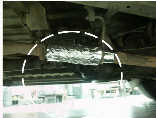
รูปที่ 4-14 ตำแหน่งการวัดอุณหภูมิอากาศเข้าที่ท่อไอดีและไอเสียบริเวณผิวท่อไอเสีย
