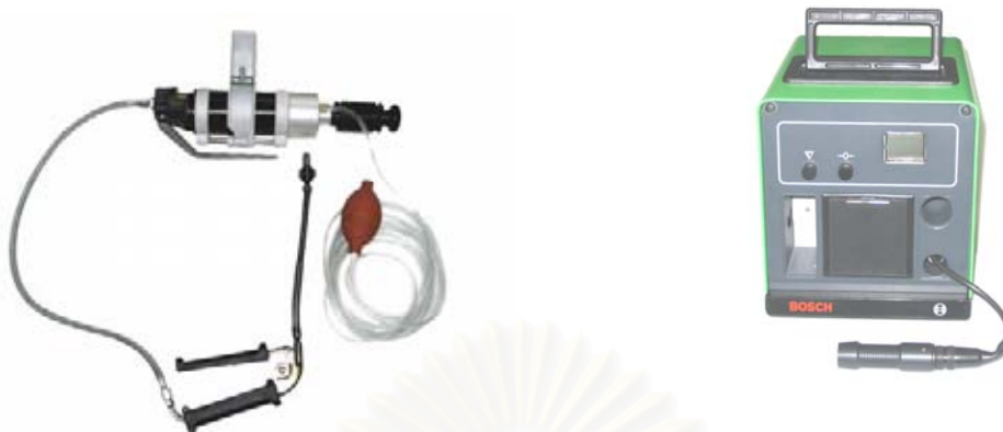
รูปที่ 4-27 ชุดเครื่องมือวัดค่าควันท้ำ ประกอบด้วยปั๊มดูดไอเสีย รุ่น ETD 020.00 (ซ้าย) เครื่องอ่านค่าควันท้ำ รุ่น ETD 020.50 (ขวา)
