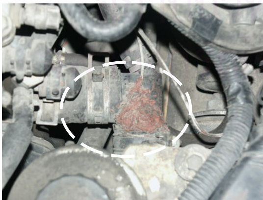
รูปที่ 4-15 ตำแหน่งการวัดอุณหภูมิ ที่ทางน้ำเข้าและน้ำออกจากเครื่องยนต์
