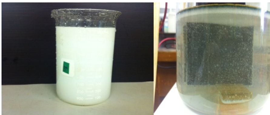
ภาพที่ 4.14 ลักษณะของน้ำเสียก่อนการบำบัดและหลังจากผ่านการบำบัดด้วย กระบวนการรวมตะกอนทางไฟฟ้า
