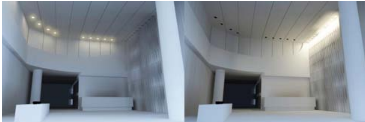
ภาพที่ 4.317 แสดงรูปจำลอง 3 มิติ พื้นที่โถงต้อนรับของโรงแรมฤทธิ ร่วมกับแสงประดิษฐ์ในรูปแบบ Downlight และ Wallwashing (จากซ้ายไปขวา)
