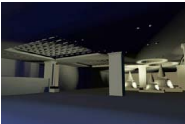
ภาพที่ 4.84 แสดงรูปจำลอง 3 มิติ พื้นที่โถงต้อนรับของโรงแรมตรีมร่วมกับแสงประดิษฐ์ ในรูปแบบ Downlight และ Uplight ที่ส่องเน้นบริเวณเจดีย์
