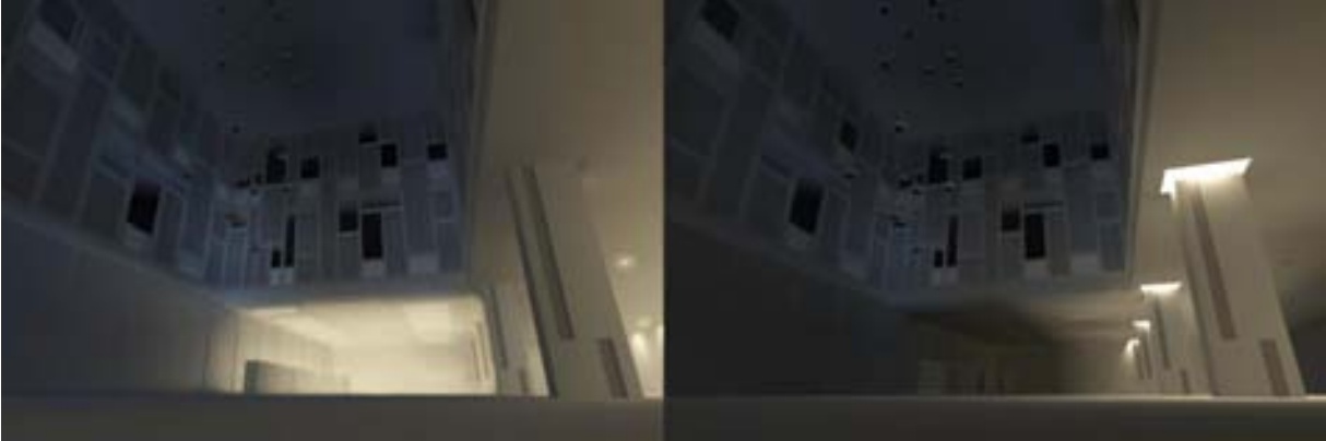
ภาพที่ 4.77 แสดงรูปจำลอง 3 มิติ พื้นที่โถงต้อนรับของโรงแรมเรอเนสซองซ์ กรุงเทพฯ ราชประสงค์ ร่วมกับแสงประดิษฐ์ในรูปแบบ Downlight และ Cove Lighting (จากซ้ายไปขวา)
