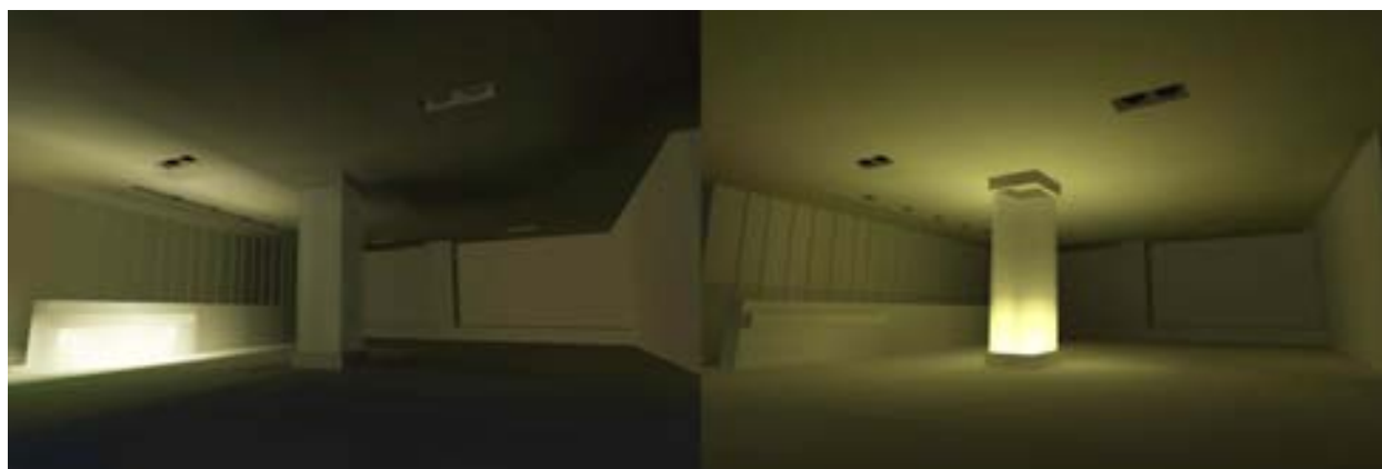
ภาพที่ 4.42 แสดงรูปจำลอง 3 มิติ พื้นที่โถงต้อนรับของโรงแรมซีตรัส สุขุมวิท 22 ร่วมกับแสงประดิษฐ์ในรูปแบบ Cove Lighting และ Glow Lighting (จากซ้ายไปขวา)
