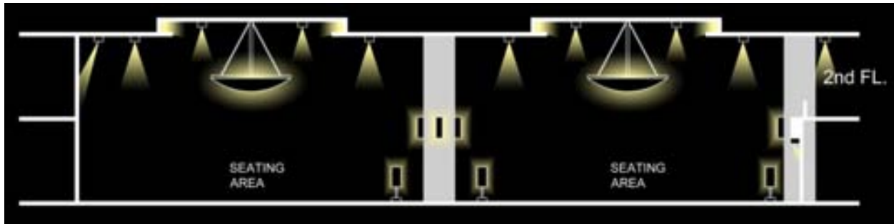
ภาพที่ 4.146 รูปตัด A ที่แสดงรูปแบบของแสงประดิษฐ์ในส่วนโถงต้อนรับของ โรงแรมแกรนด์ เซ็นเตอร์พอยต์ ราชดำริ
