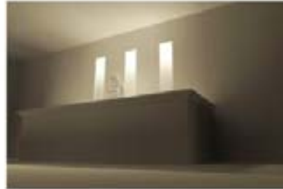
ภาพที่ 5.29 ภาพ 3 มิติ แสดงลักษณะไฟแบบ Cove Lighting บริเวณผนังด้านหลังเคาน์เตอร์
