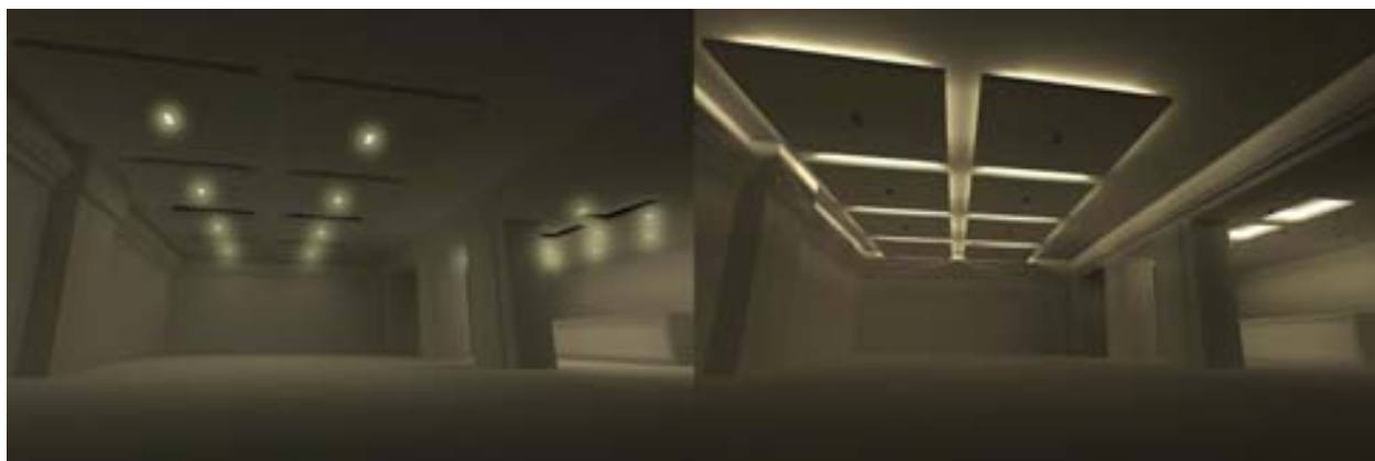
ภาพที่ 4.139 แสดงรูปจำลอง 3 มิติ พื้นที่โถงต้อนรับของโรงแรมโรงแรมแกรนด์ เพอร์สซิเดนซ์ กรุงเทพฯ ร่วมกับแสงประดิษฐ์ในรูปแบบ Downlight และ Cove Lighting (จากซ้ายไปขวา)
