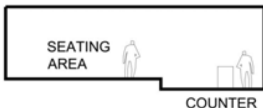
ภาพที่ 5.3 ตัวอย่างรูปตัดที่แสดงการแบ่งขอบเขตโดยความต่างของระดับพื้น
