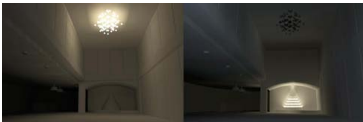
ภาพที่ 4.267 แสดงรูปจำลอง 3 มิติ พื้นที่โถงต้อนรับของโรงแรมรามาดา อังคอร์ กรุงเทพฯ ร่วมกับแสงประดิษฐ์ในรูปแบบ Decorative Lighting และ Accent Lighting (จากซ้ายไปขวา)
