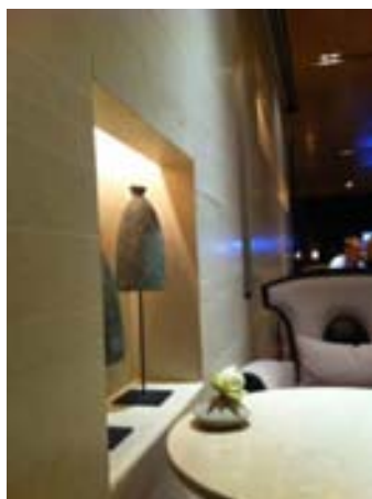
ภาพที่ 2.15 แสดงตัวอย่างการใช้ไฟแบบ Accent lighting ในอาคารประเภทโรงแรม
