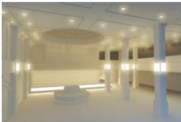
ภาพที่ 6.26 แสดงรูปจำลอง 3 มิติ ในบริเวณด้านหน้า และด้านหลังเคาน์เตอร์ต้อนรับของโรงแรมสยามซิตี ร่วมกับแสงประดิษฐ์ในรูปแบบ Glow Lighting โดยฝ้าเพดานเลือกใช้ไฟแบบ Downlight, เสาเลือกใช้ไฟแบบ Wall Sconce และผนังเลือกใช้ไฟแบบ Accent Lighting และ Wallwashing
