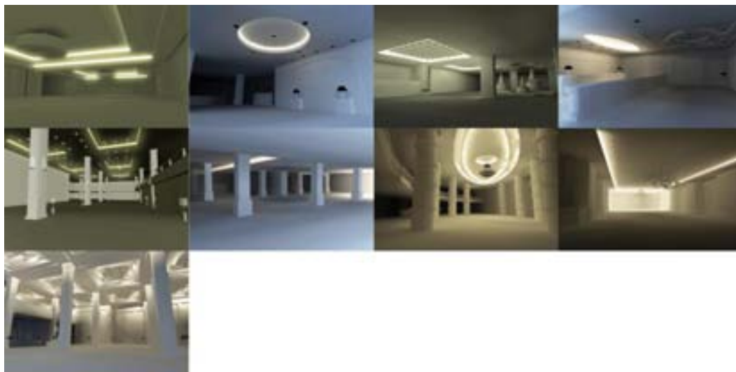
ภาพที่ 5.48 ภาพ 3 มิติ ของกรณีศึกษาที่มีฝ้าเพดานหลุม และเลือกใช้ไฟแบบ Cove Lighting
