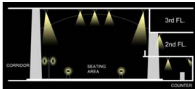
ภาพที่ 3.5 ภาพแสดงลักษณะการใช้โปรแกรม Adobe Photoshop จำลององค์ประกอบและทิศทางของแสงประดิษฐ์ที่เกิดขึ้นในรูปตัด
