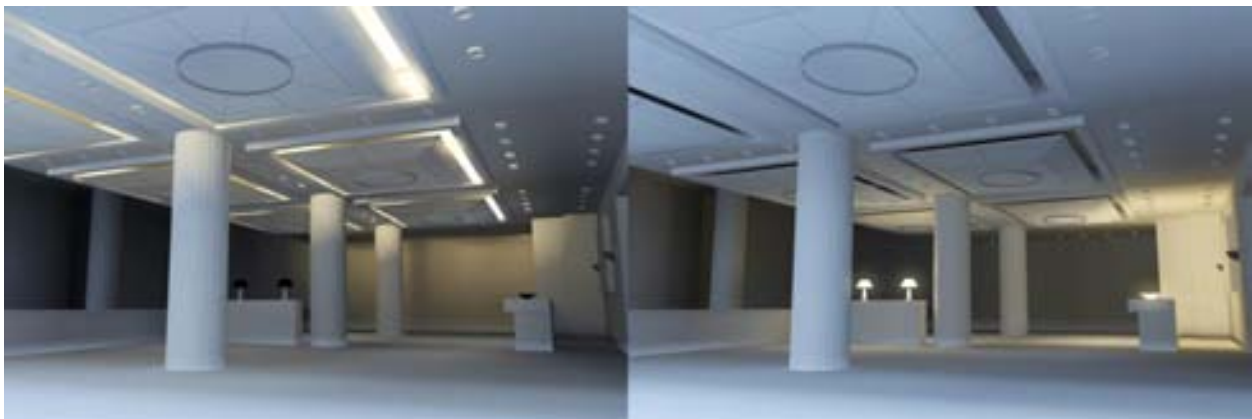
ภาพที่ 4.33 แสดงรูปจำลอง 3 มิติ พื้นที่โถงต้อนรับของโรงแรมบันยันทรี ร่วมกับแสงประดิษฐ์ในรูปแบบ Cove Lighting และ Task Lighting (จากซ้ายไปขวา)
