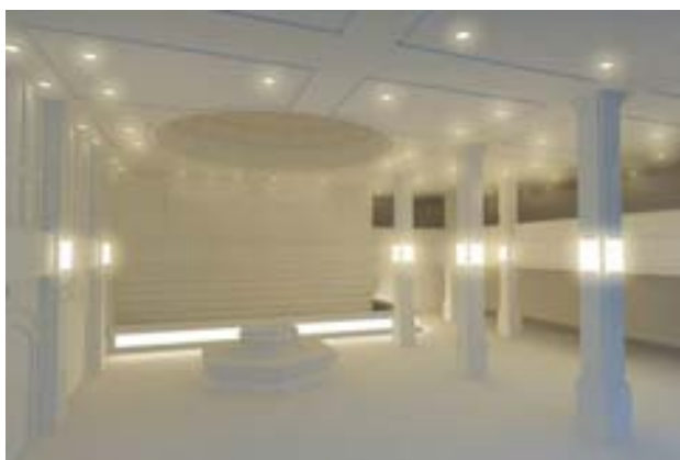
ภาพที่ 6.24 แสดงรูปจำลอง 3 มิติ ในบริเวณด้านหน้าเคาน์เตอร์ต้อนรับของโรงแรมสยามซิตี ร่วมกับแสงประดิษฐ์ในรูปแบบ Glow Lighting โดยฝ้าเพดานเลือกใช้ไฟแบบ Downlight, เสาเลือกใช้ไฟแบบ Wall Sconce และผนังเลือกใช้ไฟแบบ Accent Lighting และ Wallwashing
