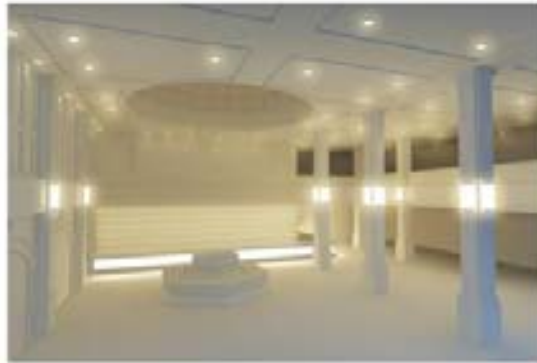
ภาพที่ 6.26 แสดงรูปจำลอง 3 มิติ ในบริเวณด้านหน้า และด้านหลังเคาน์เตอร์ต้อนรับของโรงแรมสยามซิตี้ ร่วมกับแสงประดิษฐ์ในรูปแบบ Glow Lighting โดยมีภาพตามเลือกใช้ไฟแบบ Downlight, เสาเลือกใช้ไฟแบบ Wall Sconce และผนังเลือกใช้ไฟแบบ Accent Lighting และ Wallwashing
