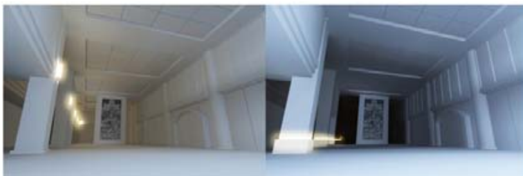
ภาพที่ 6.7 แสดงรูปจำลอง 3 มิติ เสาสี่เหลี่ยมของโรงแรมเซ็นจูรี่ พาร์ค ร่วมกับแสงประดิษฐ์ในรูปแบบ Wall Sconce และ Uplight (จากซ้ายไปขวา)
