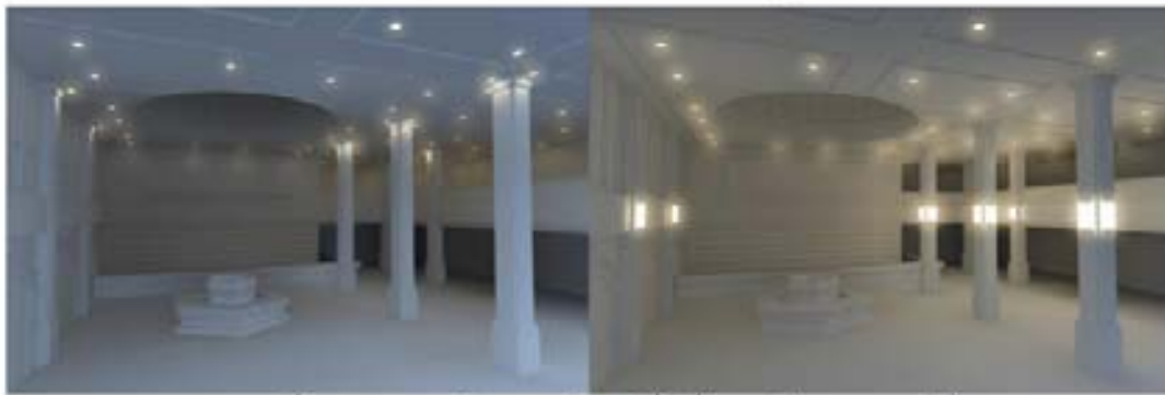
ภาพที่ 6.20 แสดงรูปจำลอง 3 มิติ เสาสี่เหลี่ยมของโรงแรมสยามซิตี้ ร่วมกับแสงประดิษฐ์ในรูปแบบ Wallwashing และ Wall Sconce (จากซ้ายไปขวา) โดยฝ้าเพดานเลือกใช้ไฟแบบ Downlight
