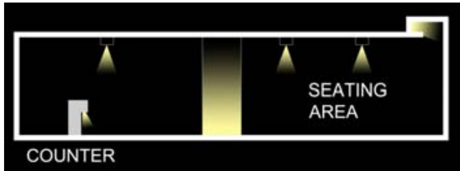
ภาพที่ 4.39 รูปตัดที่แสดงรูปแบบของแสงประดิษฐ์ในส่วนโถงต้อนรับของโรงแรมซีตรัส สุขุมวิท 22
