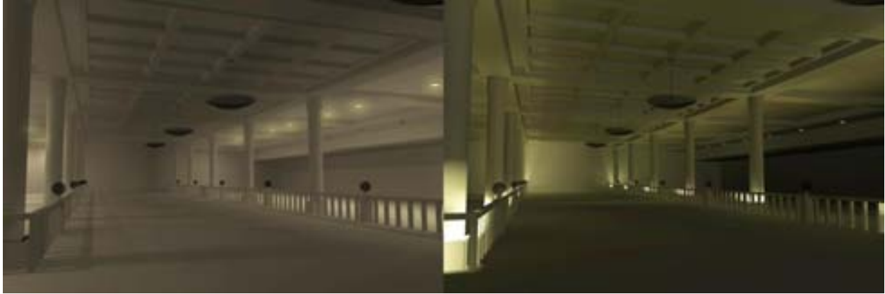
ภาพที่ 4.176 แสดงรูปจำลอง 3 มิติ พื้นที่โถงต้อนรับของโรงแรมอิมพีเรียล คิวินส์ปาร์ค ร่วมกับแสงประดิษฐ์ในรูปแบบ Downlight และ Uplight (จากซ้ายไปขวา)
