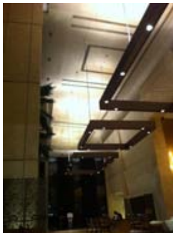
ภาพที่ 2.10 แสดงตัวอย่างการใช้ไฟแบบ Uplight ในอาคารประเภทโรงแรม
