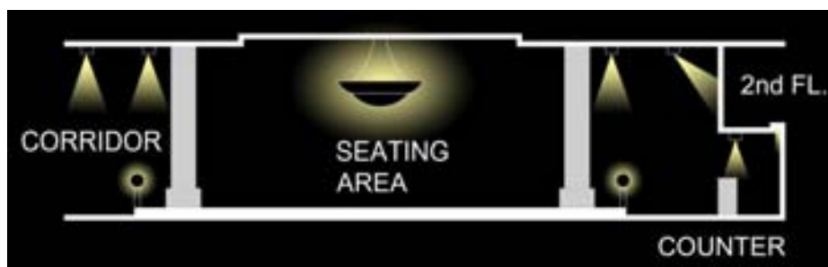
ภาพที่ 4.174 รูปตัดที่แสดงรูปแบบของแสงประดิษฐ์ในส่วนโถงต้อนรับของโรงแรมอิมพีเรียล คิวินส์ปาร์ค
