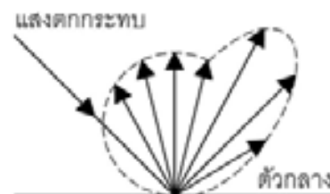
ภาพที่ 2.6 แสดงการสะท้อนแสงแบบการกระจายแสงแบบกระจาย (ที่มา : พรรณชรัล สุริโยธิน .วัสดุและการก่อสร้างหลอดไฟฟ้า, 2548 (ดัดแปลง))
