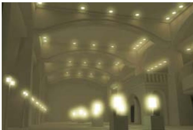
ภาพที่ 3.7 ภาพแสดงลักษณะการใช้โปรแกรม Artlantis จำลององค์ประกอบและทิศทางของแสงประดิษฐ์ที่เกิดขึ้นในภาพ 3 มิติ
