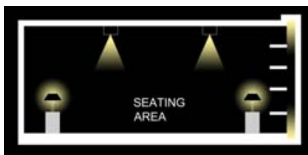
ภาพที่ 4.295 รูปตัด B ที่แสดงรูปแบบของแสงประดิษฐ์ในส่วนโถงต้อนรับของโรงแรมโซฟิเทล กรุงเทพฯ สีลม
