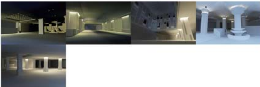
ภาพที่ 5.53 ภาพ 3 มิติ ของกรณีศึกษาที่มีพื้นที่สูงน้อยกว่า 2 ชั้น และเลือกใช้ไฟแบบ Cove Lighting กับเสาในพื้นที่
