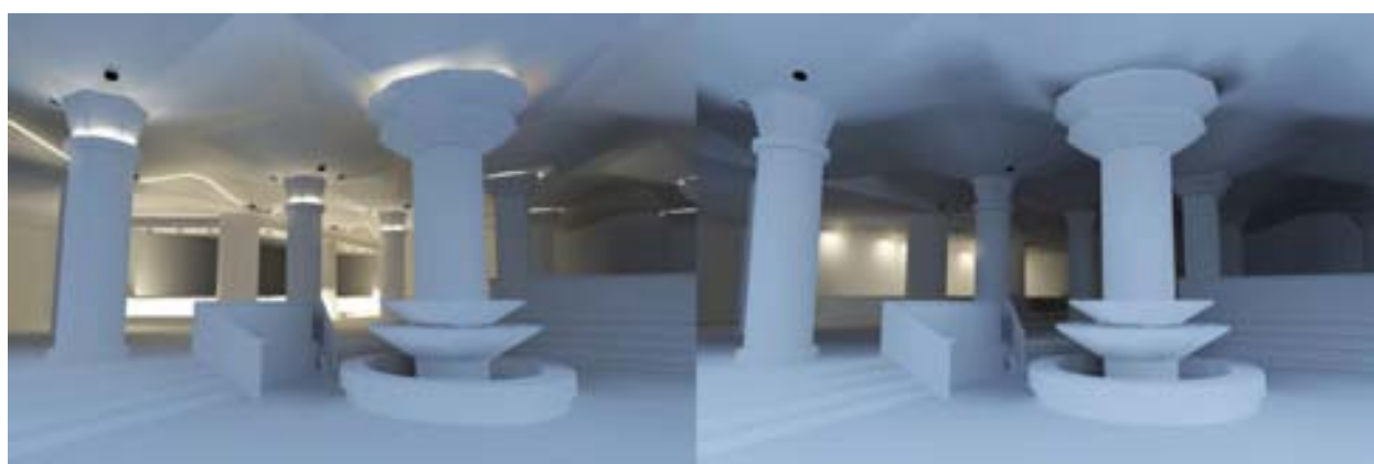
ภาพที่ 4.92 แสดงรูปจำลอง 3 มิติ พื้นที่โถงต้อนรับของโรงแรมดุสิตธานี กรุงเทพฯ ร่วมกับแสงประดิษฐ์ ในรูปแบบ Cove Lighting และ Wallwashing (จากซ้ายไปขวา)
