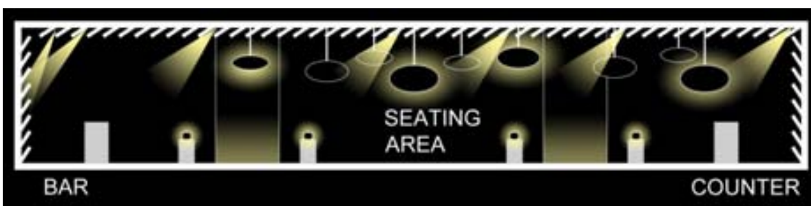
ภาพที่ 4.304 รูปตัด A ที่แสดงรูปแบบของแสงประดิษฐ์ในส่วนโถงต้อนรับของ โรงแรมโซฟีเทล โซ แบ็งค็อก
