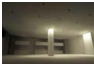
ภาพที่ 5.58 ภาพ 3 มิติ ของกรณีศึกษาที่มีพื้นที่สูง 2-3 ชั้น และเลือกใช้ไฟแบบ Wallwashing กับเสาในพื้นที่
