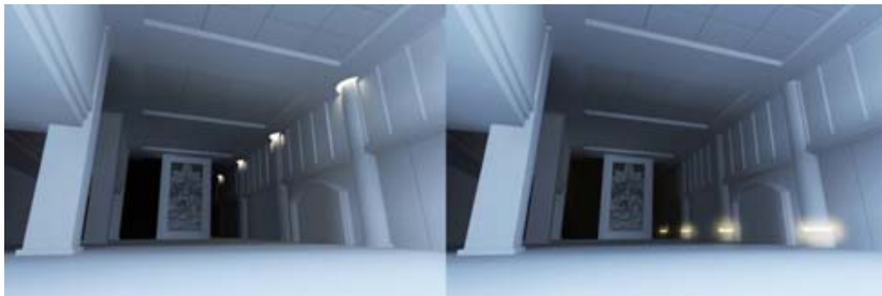
ภาพที่ 6.8 แสดงรูปจำลอง 3 มิติ เสากลมของโรงแรมเซ็นจูรี พาร์ค ร่วมกับแสงประดิษฐ์ในรูปแบบ Cove lighting และ Uplight (จากซ้ายไปขวา)
