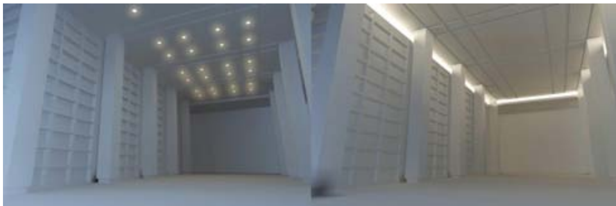
ภาพที่ 6.11 แสดงรูปจำลอง 3 มิติ ฝ้าเพดานหลุมของโรงแรมพูลแมน บางกอก คิงเพาเวอร์ ร่วมกับแสงประดิษฐ์ในรูปแบบ Downlight และ Cove Lighting (จากซ้ายไปขวา)
