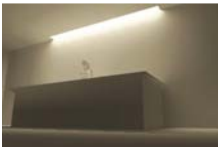
ภาพที่ 5.34 ภาพ 3 มิติ แสดงลักษณะไฟแบบ Slot Outing บริเวณผนังด้านหลังเคาน์เตอร์
