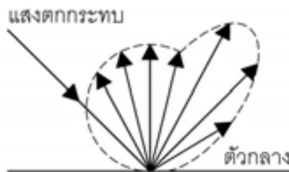
ภาพที่ 2.6 แสดงการสะท้อนแสงแบบการกระจายแสงแบบกระจาย (ที่มา : พรรณชลัท สุริโยธิน .วัสดุและการก่อสร้างหลอดไฟฟ้า, 2548 (ดัดแปลง))
