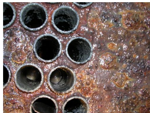
ภาพที่ 3.20 การอุดตันของ Tube ใน Condenser
