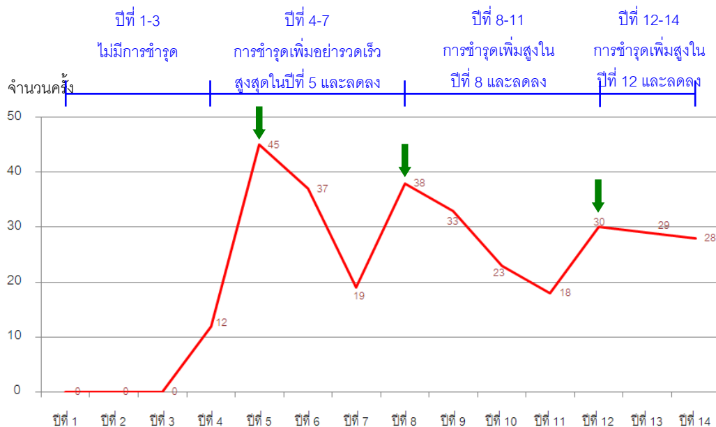
แผนภูมิที่ 4.17 จำนวนครั้งการชำรุดในส่วนของ Pump ช่วงปีที่ 1-14
