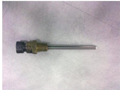
ภาพที่ 3.33 Water Temperature Sensor
