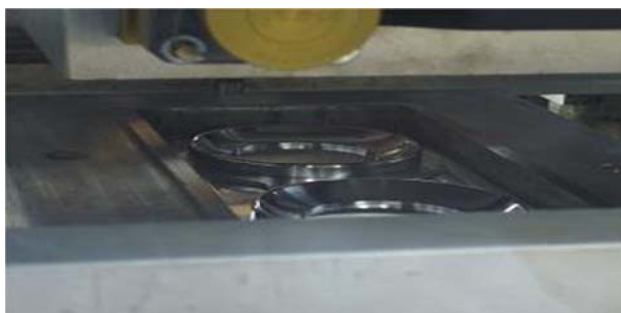
ภาพที่ 3.12 ขึ้นรูปแผ่นฟิล์มด้วยแม่พิมพ์เรือนไมล์
