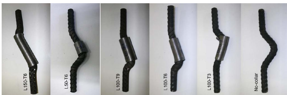
ภาพที่ 2.11 ความเสียหายของเหล็กเสริมที่ความเครียด 0.13 (Sawaraj, 2010)
