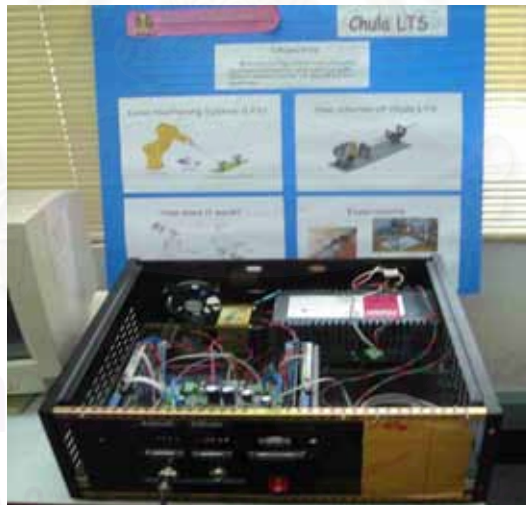
รูปที่ 5.12 กล่องระบบไฟฟ้าของอุปกรณ์ LTS (สำหรับ LTS หนึ่งชุด)
