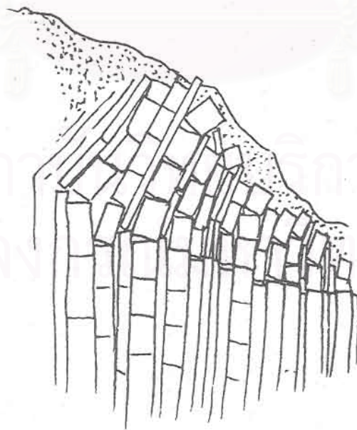
รูปที่ 46 Block flexure toppling ที่มีลักษณะเป็น column ยาว และมี cross joints จำนวนมาก
