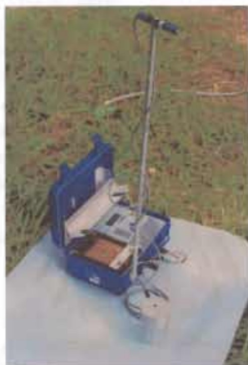
รูปที่ 4.7 เครื่องตรวจวัดการสั่นสะเทือนและเสียงดังระบบดิจิทัล โดยใช้ Transducer กับ Microphone แล้วบันทึกผลในกระดาษกราฟ
