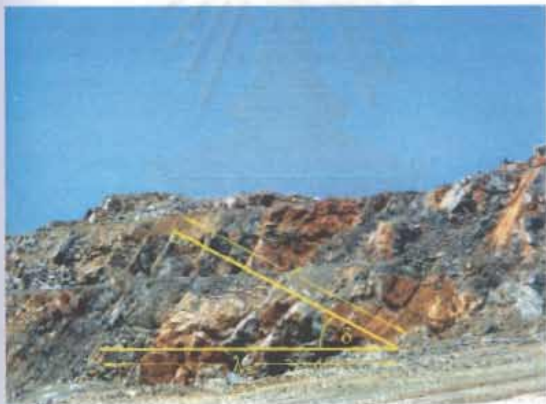
รูปที่ 2.8 ภาพถ่ายการตัดทะลักแบบจัมโบ้ดิน ในเหมืองเปิดหินปูนของบริษัท ปูนซีเมนต์เอเชีย อำเภอพระพุทธบาท สระบุรี แสดงระนาบ ของ joints ที่ปรากฏ สัญลักษณ์ในภาพ l = set normal, \lambda_s = assumed sampling line, \delta = acute angle
