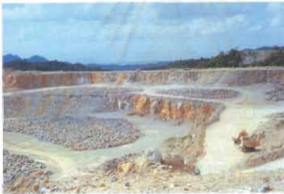
รูปที่ 7.3 การเปิดหน้าเหมืองโดยให้มีระดับลดต่ำลงจากพื้นผิว เพื่อช่วยให้เกิดทัศนียภาพของการมองดีขึ้น และลดผลกระทบต่อสิ่งแวดล้อม ได้อย่างมีประสิทธิภาพ ถ่ายที่หน้าเหมืองบริษัทปูนซีเมนต์นครหลวง จ. สระบุรี
