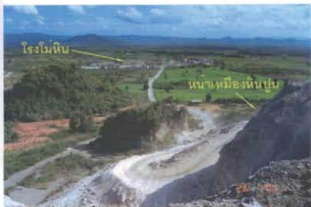
รูปที่ 6.12 ภาพถ่ายมุมกว้างแสดงเส้นทางขนส่งลำเลียงหินที่แตกหัก ภายหลังจากการระเบิด ระหว่างหน้าเหมืองหินไปยังโรงโม่หินย่อย ถ่ายในเดือนกรกฎาคม 2543 ที่เหมืองศรีปฐมอุตสาหกรรม อ. จอมบึง จ.ราชบุรี
