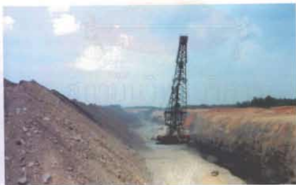
รูปที่ 5.6 ลักษณะงานการตัดร่องแนวยาว (trench) กองวัสดุหน้างานค่อนข้างเตี้ย และพื้นที่ระดับฐานค่อนข้างแน่น เหมาะสำหรับเลือกใช้รถตักเสยแบบขุดลากมักใช้ในเหมืองถ่านหิน
