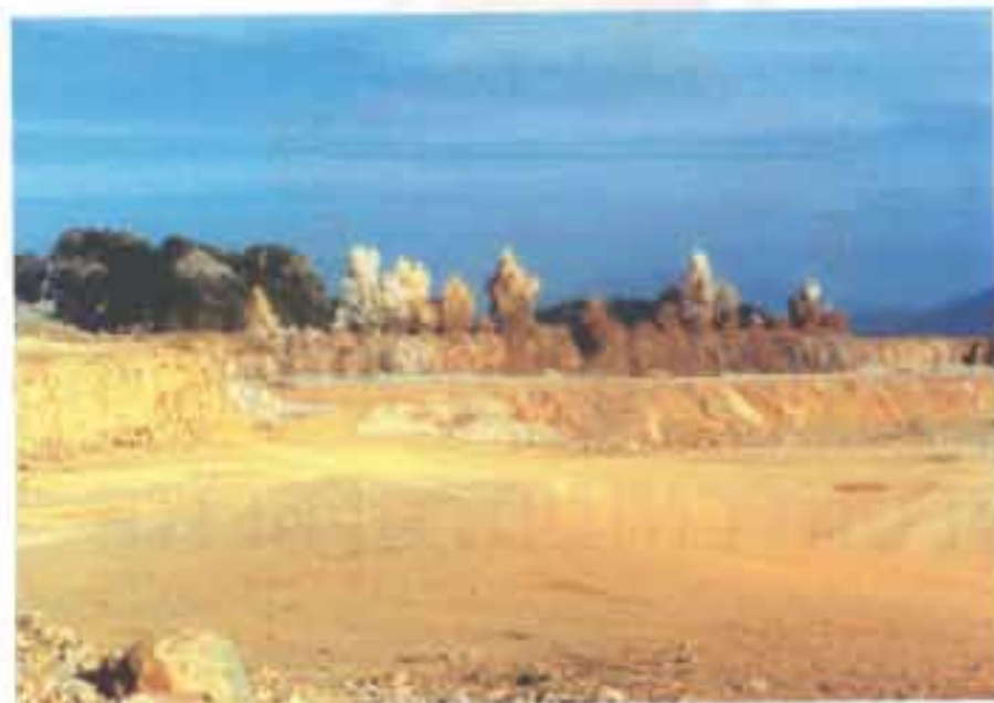
รูปที่ 7.2 การออกแบบระเบิดหน้างานในเหมืองหินขนาดใหญ่ ที่มีการใช้ แก๊สไฟฟ้าจังหวะต่าง เพื่อให้มีการระเบิดแต่ละแถวไม่พร้อมกัน
