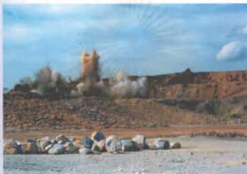
รูปที่ 1.1 ตัวอย่างหน้างานจุดเจาะที่ใช้วัตถุระเบิด ส่วนใหญ่เป็นเหมืองเปิดหินปูน มีการผลิตหินส่งโรงโม่บดย่อย เพื่อนำมาใช้ในงานก่อสร้างกับทำซีเมนต์
