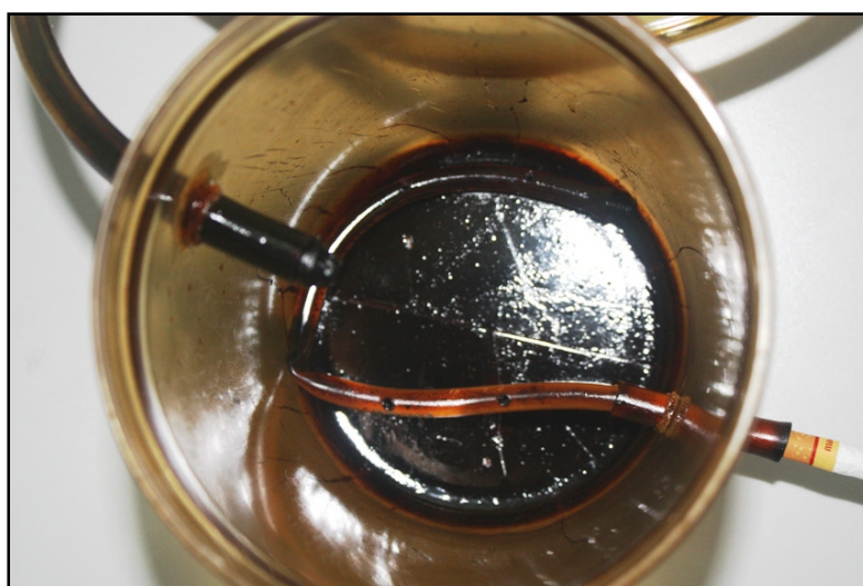
ภาพที่ 27 แสดงคราบน้ำมันทาร์ที่ติดบริเวณท่ออย่างที่คุณดูควันบุหรี่และกล่องสำหรับรมควันบุหรี่
