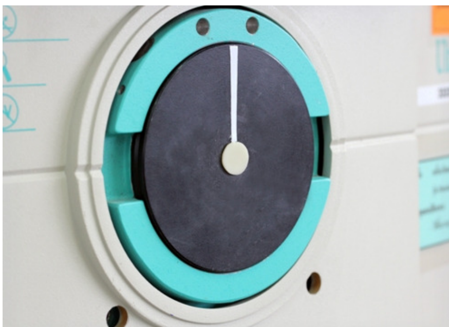
ภาพที่ 13 แสดงตำแหน่งขึ้นตัวอย่างที่วางแนบกับช่องวัดสีของเครื่องวัดสี
