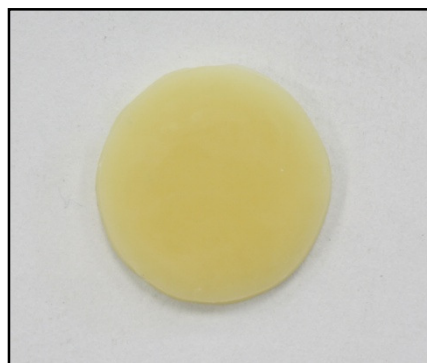
ภาพที่ 24 แสดงชิ้นตัวอย่าง Multilink Speed หลังผ่านการเร่งอายุ
