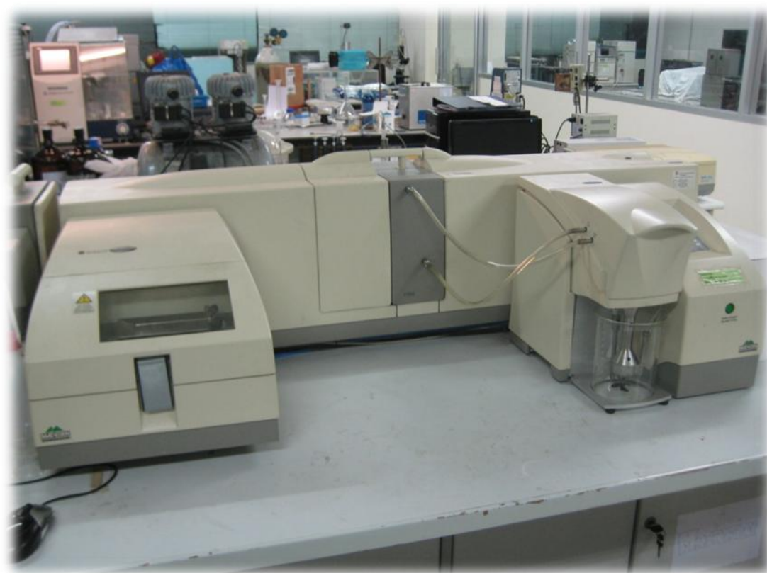
ภาพที่ 3.7 เครื่อง Laser Diffraction Analyzer บริษัท Malvern (England) รุ่น Mastersizer 2000
