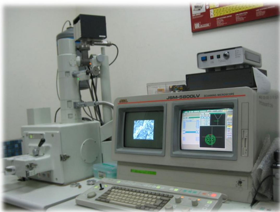
ภาพที่ 3.6 กล้องจุลทรรศน์อิเล็กตรอนแบบส่องกราดบริษัท JEOL (Japan) รุ่น JSM 5800-LV
