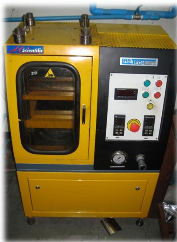
ภาพที่ 3.3 เครื่องขึ้นรูปแบบอัด บริษัท Labtech (United Kingdom)
