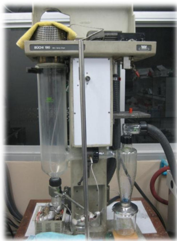
ภาพที่ 3.1 เครื่องอบแห้งแบบฟืนฝอยบริษัทBuchi (Switzerland) รุ่น B-190
