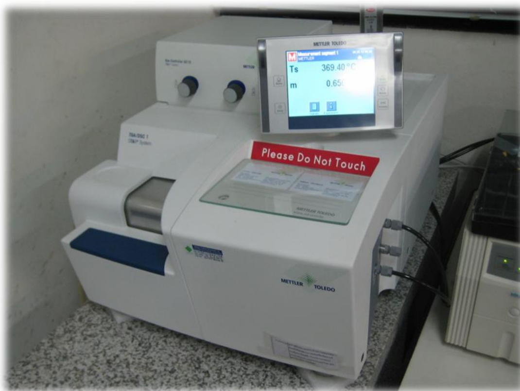
ภาพที่ 3.8 เครื่อง Thermogravimetric Analyzer บริษัท Mettler Toledo (Thailand) รุ่น TG/DC1
