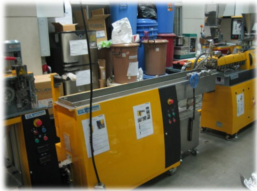
ภาพที่ 3.2 เครื่องอัดรีดแบบสกรูคู่ บริษัท Labtech (United Kingdom) รุ่น LTE 20-40
