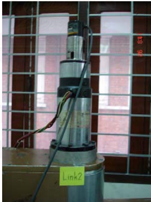
รูปที่ ก.4 มอเตอร์ Electro-Craftและเอนโคเดอร์ RENCO
