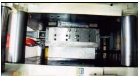
ภาพที่ 3.4 แสดงตัวอย่าง Mold ที่ใช้ในการฉีดพลาสติก
