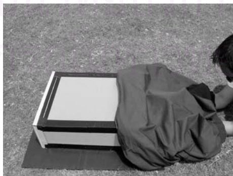
รูปที่ 3.11 แสดงการใช้ผ้าสีดำทึบแสงคลุมหุ่นจำลองขณะทำการถ่ายภาพ
