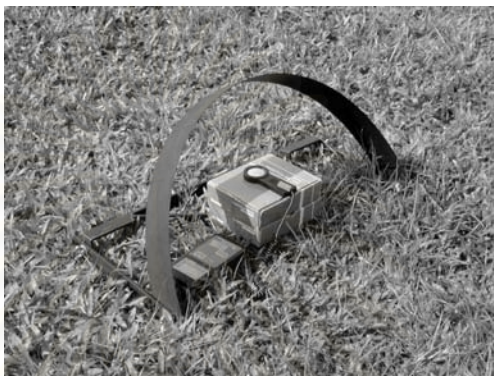
รูปที่ 3.2 แสดงวิธีจัดตั้งลักซ์มิเตอร์ที่ใช้วัดแสงภายนอกโดยไม่รวมรังสีตรงจากดวงอาทิตย์
