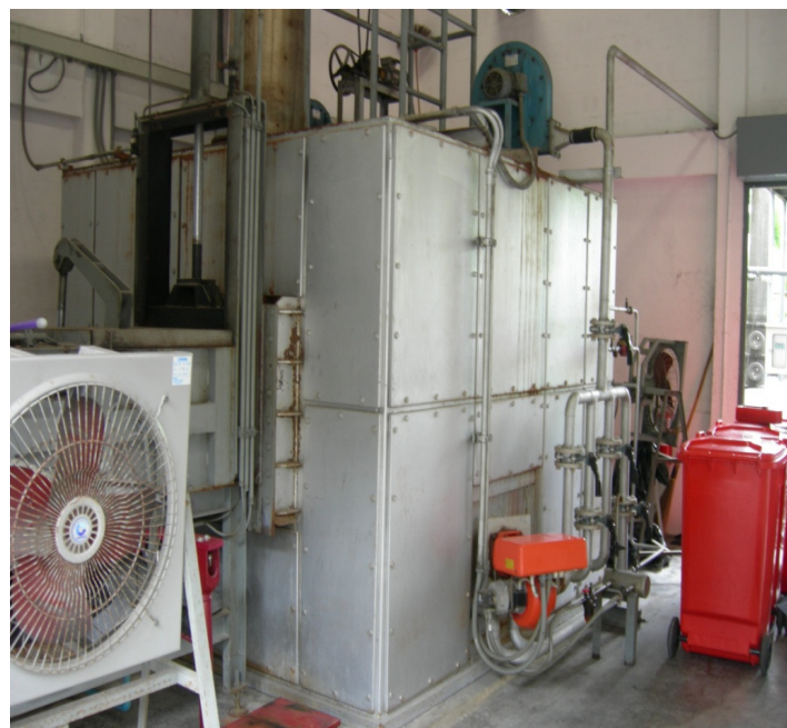
ภาพที่ 4.6 เตาเผามูลฝอยติดเชื้อที่ใช้ทำการศึกษาวิจัยก่อนการติดตั้งเครื่องอุ่นอากาศ
