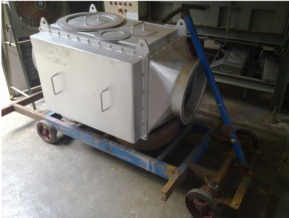
ภาพที่ 4.5 เครื่องอุ่นอากาศที่สร้างเสร็จแล้วพร้อมสำหรับการติดตั้ง
