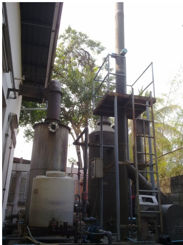
ภาพที่ 5.9 หอบำบัดไอเสียก่อนปล่อยทิ้งสู่บรรยากาศ
