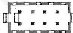
ภาพลายเส้นที่ 3.6 ผังอาคารแบบมีเสาร่วมใน
