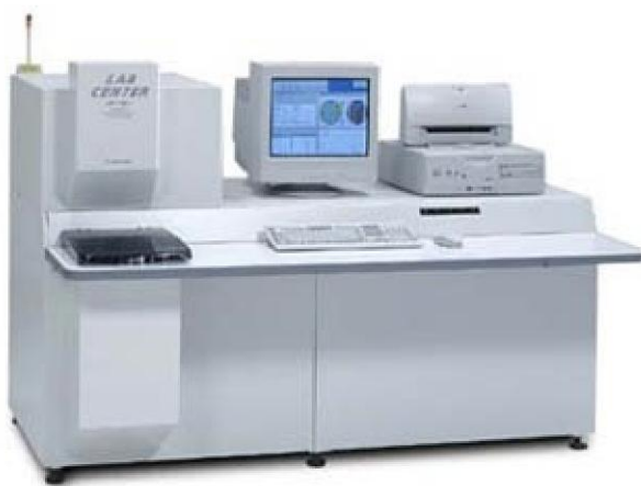
ภาพที่ ข2 เครื่องวิเคราะห์เอกซเรย์ฟลูออเรสเซนส์
