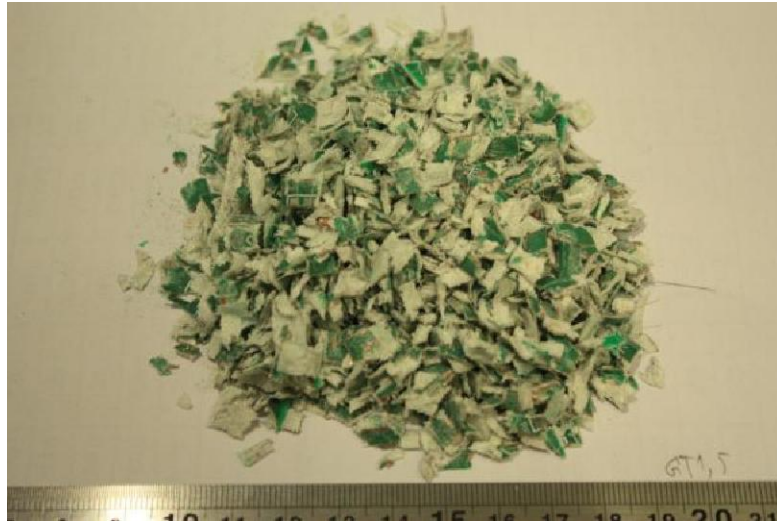
ภาพที่ ๖5 เครื่องย่อยแบบลูกกลิ้งฟันเดี่ยวตัวที่หนึ่ง ย่อยครั้งที่ 5
