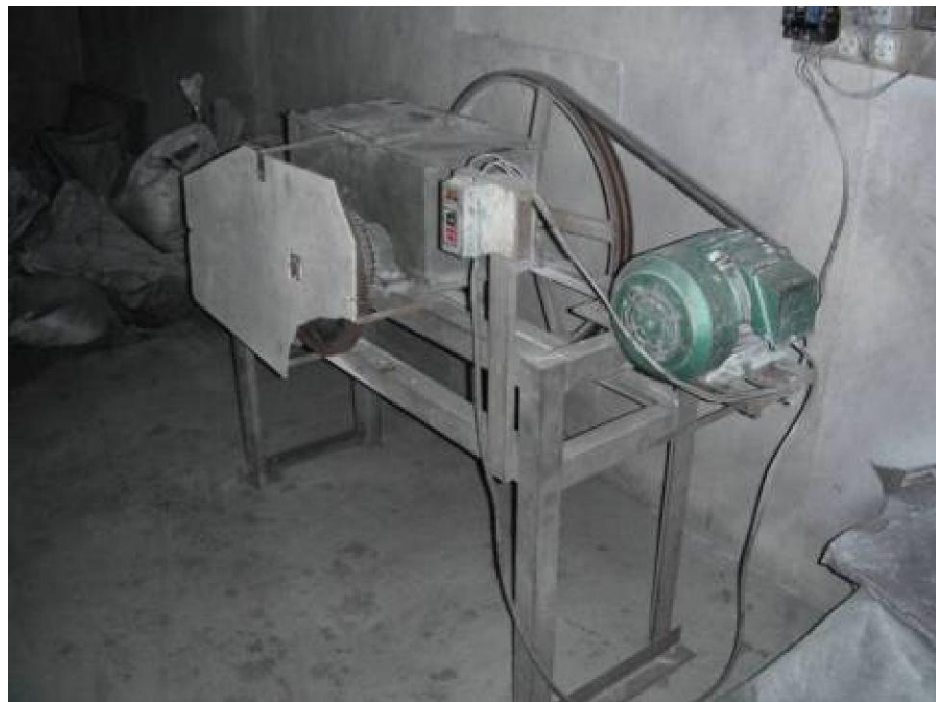
ภาพที่ 3.4 เครื่องย่อยแบบลูกกลิ้งฟันเลื่อยตัวที่สอง
