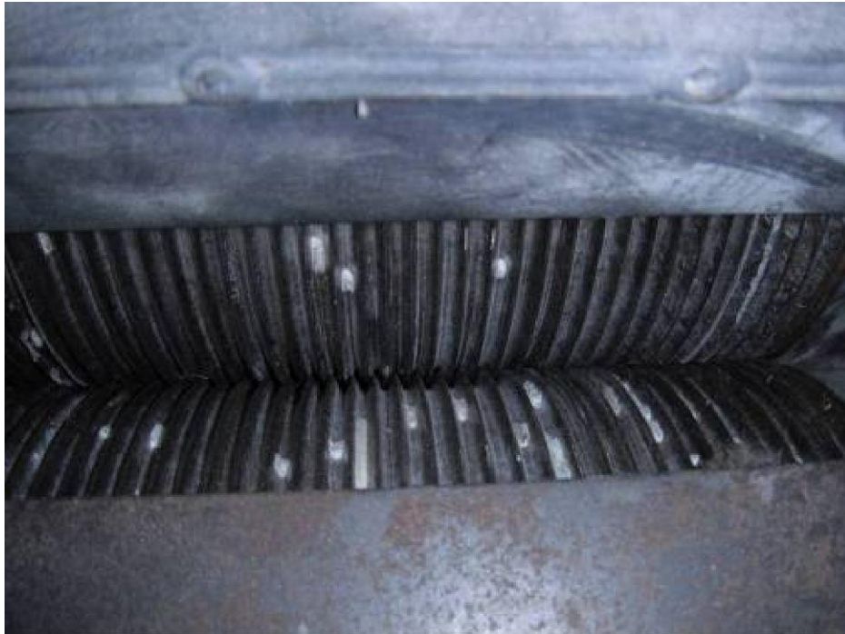
ภาพที่ 3.5 ลักษณะพื้นเลื่อยบนหน้าลูกกลิ้ง ของเครื่องย่อยแบบลูกกลิ้งพื้นเลื่อยตัวที่หนึ่ง
