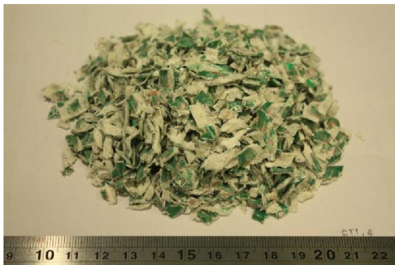
ภาพที่ ง4 เครื่องย่อยแบบลูกกลิ้งฟันเลื่อยตัวที่หนึ่ง ย่อยครั้งที่ 4
