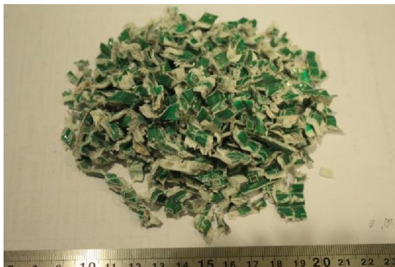
ภาพที่ ง2 เครื่องย่อยแบบลูกกลิ้งฟันเลื่อยตัวที่หนึ่ง ย่อยครั้งที่ 2
