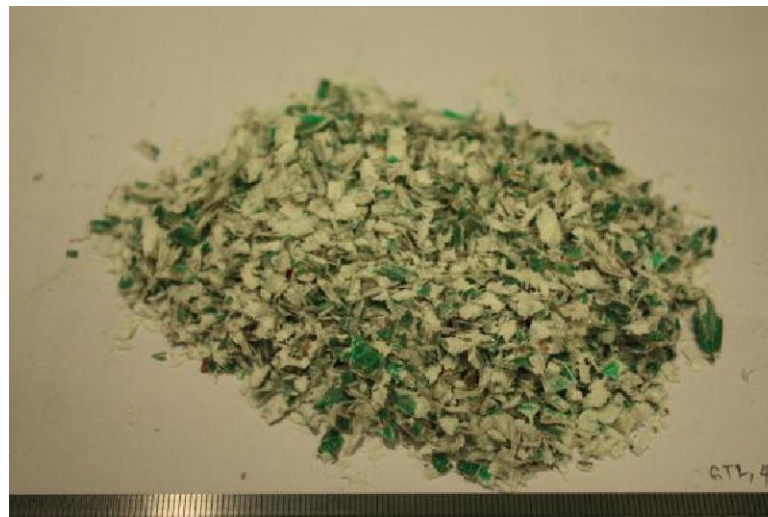
ภาพที่ ๓4 เครื่องย่อยแบบลูกกลิ้งฟันเลื่อยตัวที่สอง ย่อยครั้งที่ 4
