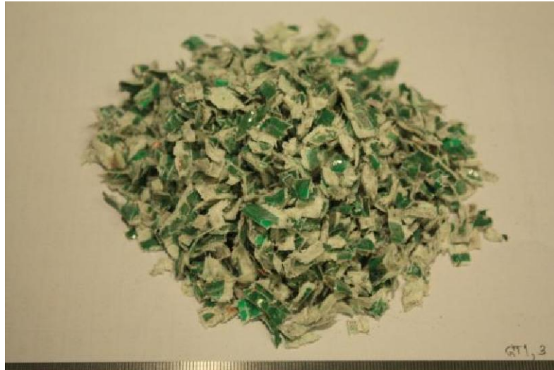
ภาพที่ ง3 เครื่องย่อยแบบลูกกลิ้งฟันเลื่อยตัวที่หนึ่ง ย่อยครั้งที่ 3
