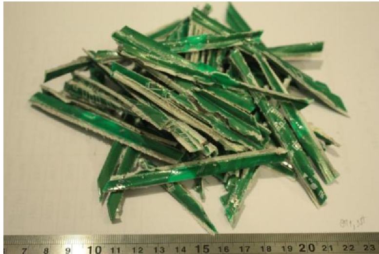
ภาพที่ ง1 เครื่องย่อยแบบลูกกลิ้งฟันเลื่อยตัวที่หนึ่ง ย่อยครั้งที่ 1
