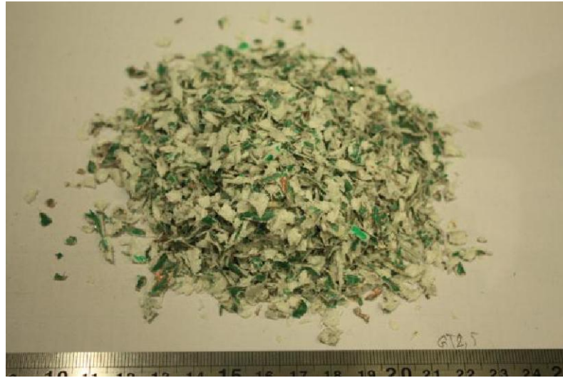
ภาพที่ ๖5 เครื่องย่อยแบบลูกกลิ้งฟันเลื่อยตัวที่สอง ย่อยครั้งที่ 5
