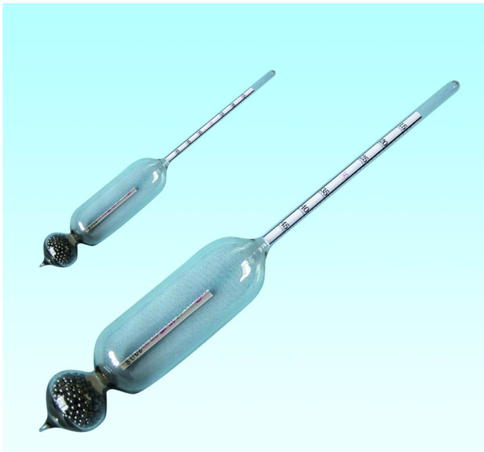
ภาพที่ ข.13 แสดงเครื่องมือวัดความถ่วงจำเพาะไฮโดรมิเตอร์ (hydrometer)
