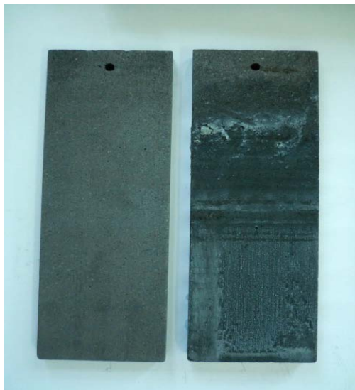
รูปที่ 4.17 ลักษณะขั้วแคโทดก่อน (ซ้าย) และหลัง (ขวา) เมื่อทำการผ่านศักย์ไฟฟ้าคงที่ที่ 7 โวลต์ ในสารละลายสกัด H_2SO_4 ที่ค่าพีเอช 1 ในเซลล์เคมีไฟฟ้าแบบมีรอยต่อของสารละลาย
