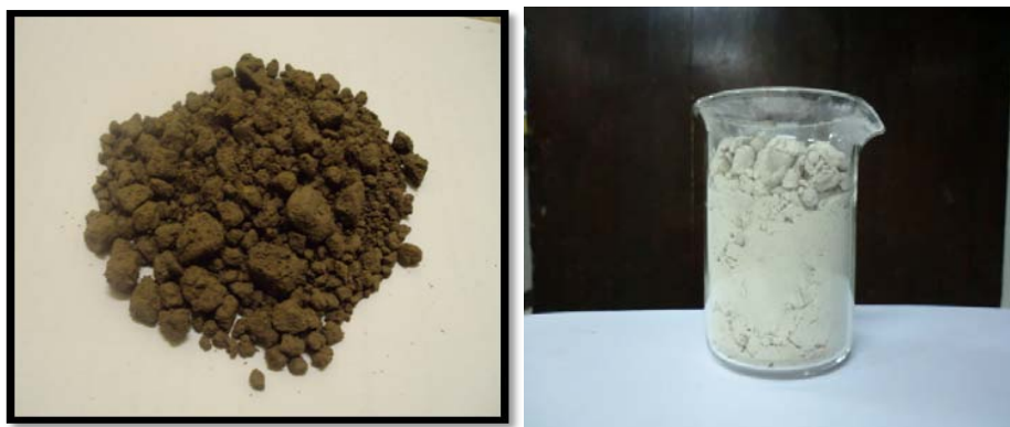
รูปที่ 4.1 ตัวอย่างกากตะกอนของเสียจากถังตกตะกอนสังกะสีทางเคมี (Zinc Clarifier) จากโรงงานอุตสาหกรรมผลิตเส้นใยเรยอน ก่อนอบแห้ง (รูปซ้าย) และหลังอบแห้ง (รูปขวา)
