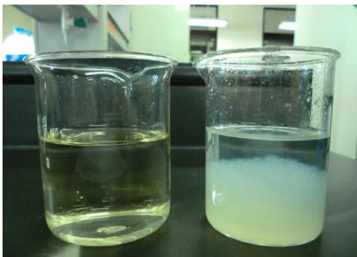
รูปที่ 4.18 ลักษณะของสารละลายสกัด H_2SO_4 ที่ค่าพีเอช 1 ก่อนทดลอง (ซ้าย) และตะกอนสีขาวที่เกิดขึ้น (ขวา) เมื่อทำการผ่านศักย์ไฟฟ้าคงที่ที่ 7 โวลต์ ในเซลล์เคมีไฟฟ้าแบบมีรอยต่อของสารละลาย
