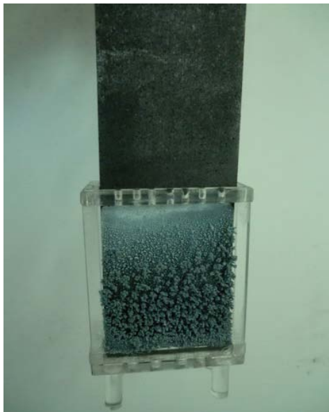
รูปที่ 4.16 ลักษณะการเข้าเกาะของสังกะสีที่ขั้วแคโทด เมื่อทำการผ่านศักย์ไฟฟ้าคงที่ที่ 7 โวลต์ในสารละลายสกัด H_2SO_4 ที่ค่าพีเอช 1 ในเซลล์เคมีไฟฟ้าแบบไม่มีรอยต่อของสารละลาย
