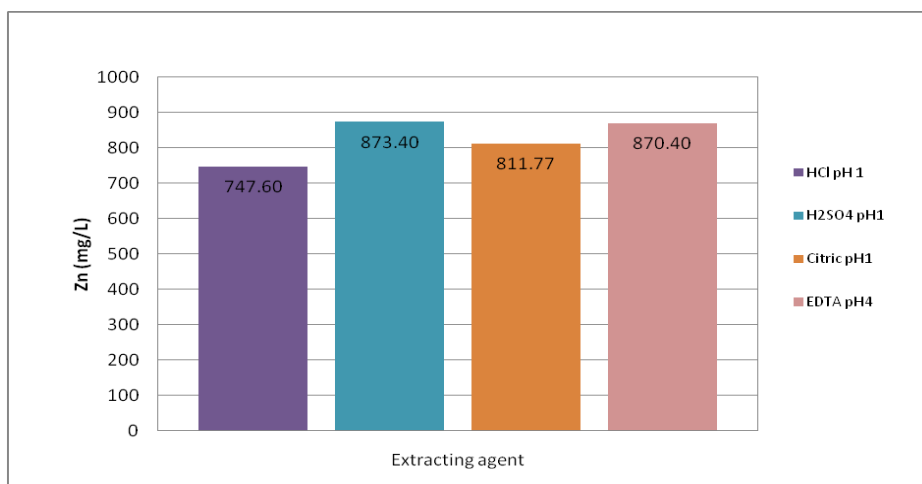
รูปที่ 4.3 ความเข้มข้นของสังกะสีที่ละลายออกมาจากกากตะกอนด้วยตัวสกัดชนิดต่าง ๆ ณ ค่าพีเอชของตัวสกัดแต่ละชนิดที่สามารถละลายสังกะสีออกจากกากตะกอนได้มากที่สุด
