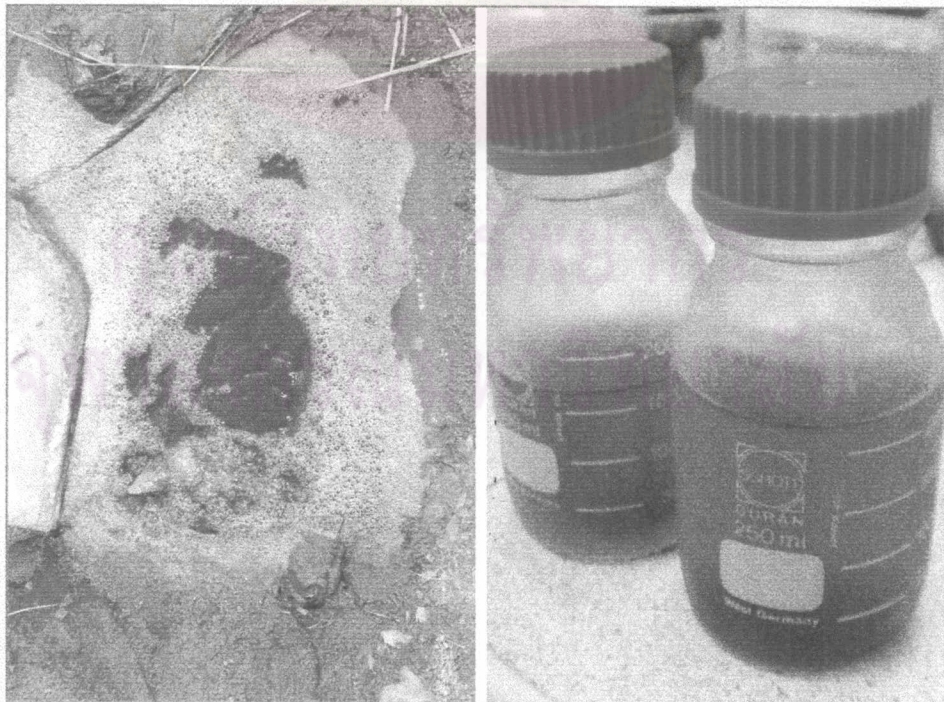
รูปที่ 4.4 บ่อรวบรวมน้ำชะมูลฝอย (Sump) และ ตัวอย่างน้ำชะมูลฝอย
