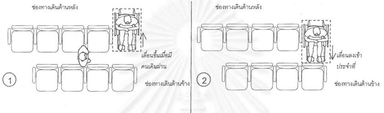
รูปที่ 71 แสดงการขับเก้าอี้ล้อเลื่อนเมื่อมีการเดินผ่านเข้า-ออกจากแถวที่นั่ง
