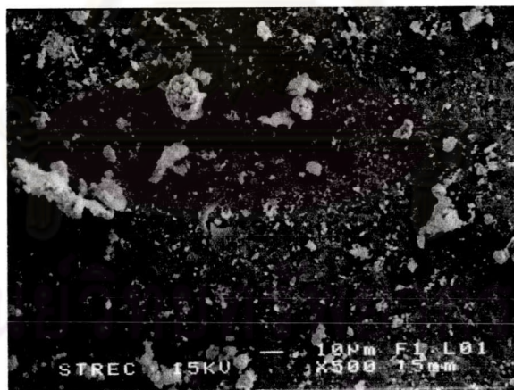
รูปที่ 4.12 SEM ของสารประกอบเชิงซ้อนระหว่างพอลิ(อะคริลิกแอซิด-โค-อะคริลาไมด์) กับ แคลเซียมไฮดรอกไซด์ ที่อัตราส่วน 1:1 กำลังขยาย 500 เท่า
