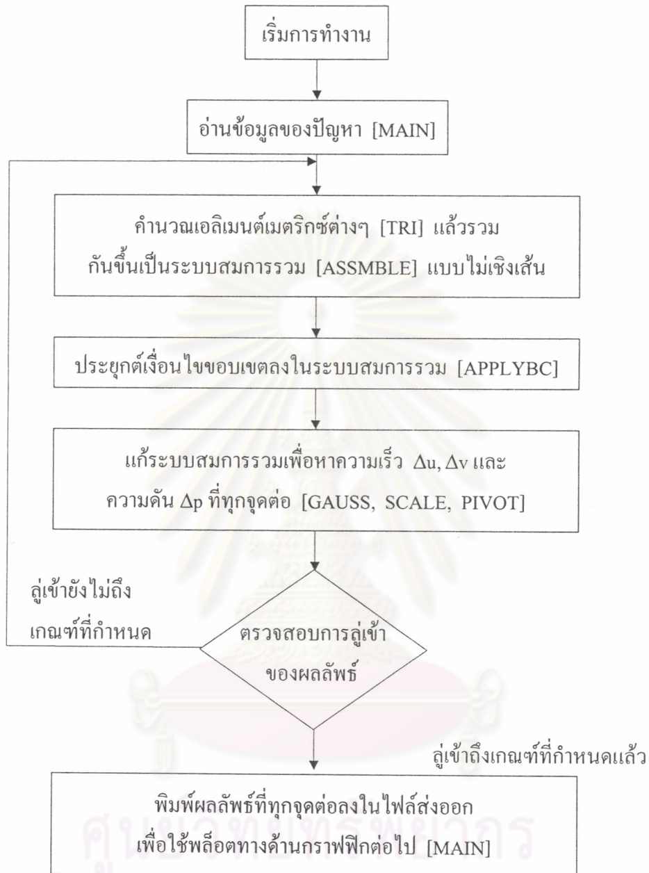
รูปที่ 4.3 แผนภูมิการทำงานของไฟไนต์เอลิเมนต์โปรแกรมคอมพิวเตอร์ NAVIER2D คำในวงเล็บสี่เหลี่ยม [ ] ระบุชื่อโปรแกรมย่อยที่ทำการคำนวณนั้น
