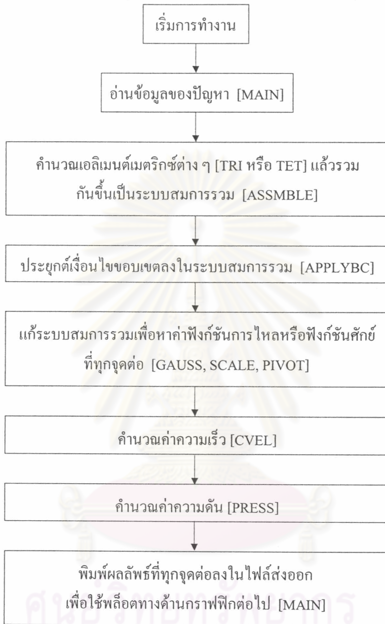
รูปที่ 4.1 แผนภูมิการทำงานของไฟไนต์เอลิเมนต์โปรแกรมคอมพิวเตอร์สำหรับการไหลแบบศักย์ คำในวงเล็บสี่เหลี่ยม [ ] ระบุชื่อโปรแกรมย่อยที่ทำการคำนวณนั้น
