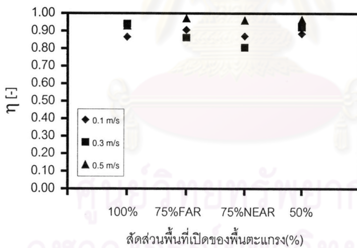
รูปที่ 6.82 ความสัมพันธ์ระหว่างประสิทธิภาพการระบายอากาศกับสัดส่วนพื้นที่เปิดของพื้นที่ระแนงกรณีเปิดพัดลมระดับ LOW ที่เป่ารบกวนกระแสอากาศภายในห้องเมื่อความสูงของผนังห้อง 1.5 เมตร
