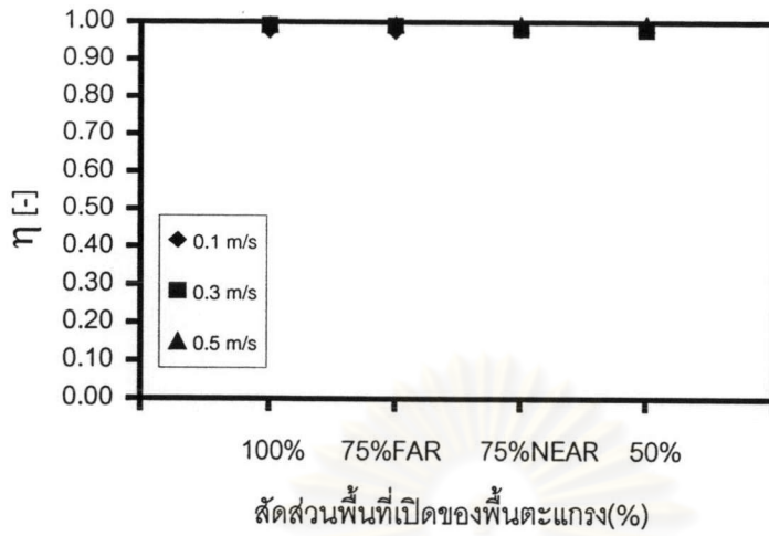
รูปที่ 6.78 ความสัมพันธ์ระหว่างประสิทธิภาพการระบายอากาศกับสัดส่วนพื้นที่เปิดของหน้าต่าง กรณีเปิดพัดลมที่เป่ารอบวงกระแสอากาศภายในห้องเมื่อความสูงของผนังห้อง 2 เมตร
