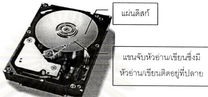
รูปที่ 3.1 ตัวอย่างแขนจับหัวอ่าน/เขียนแบบต่างๆ
