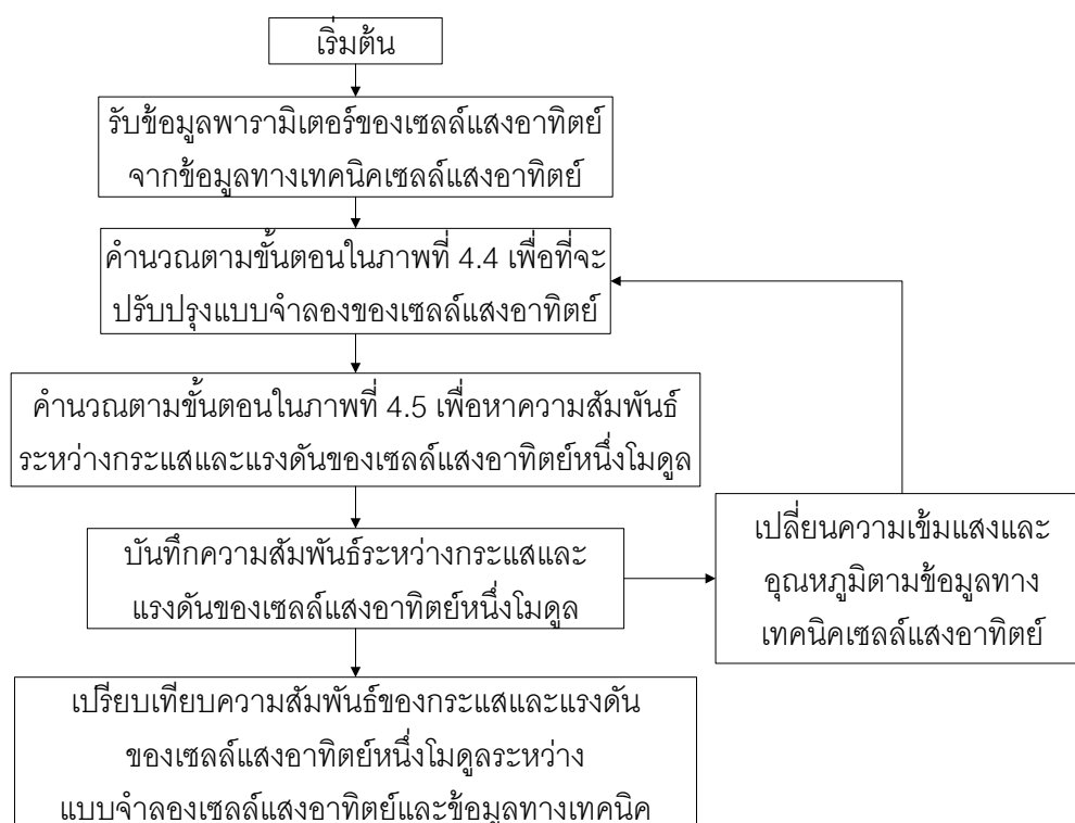
ภาพที่ 9.1 ขั้นตอนการเปรียบเทียบระหว่างผลการทดลองของแบบจำลองเซลล์แสงอาทิตย์ และข้อมูลทางเทคนิคเซลล์แสงอาทิตย์
