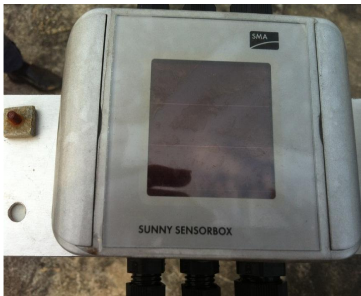
ภาพที่ 7.4 เซนเซอร์ตรวจวัดความเข้มแสงของเซลล์แสงอาทิตย์
