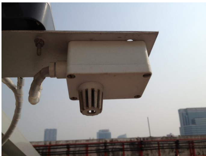
ภาพที่ 7.5 เซนเซอร์ตรวจวัดอุณหภูมิของสิ่งแวดล้อม และเซลล์แสงอาทิตย์
