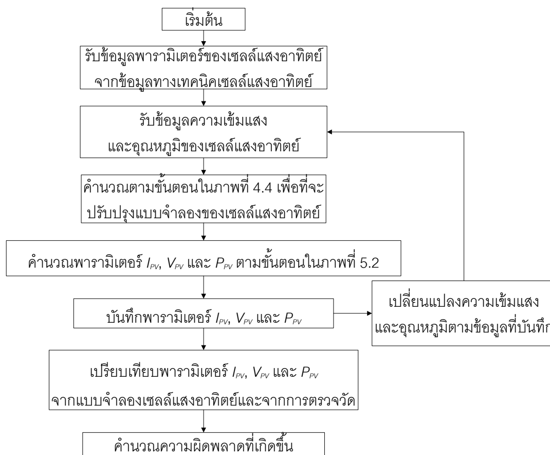
ภาพที่ 9.6 ขั้นตอนการเปรียบเทียบระหว่างผลการทดลองของแบบจำลองเซลล์แสงอาทิตย์ และผลการตรวจวัดของระบบผลิตไฟฟ้าจากเซลล์แสงอาทิตย์
