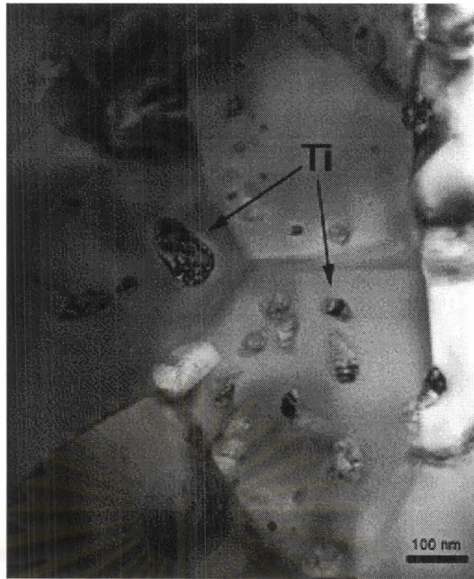
รูปที่ 2.16 ภาพขยายบริเวณ G-phase ในรูปที่ 2.15 โครงสร้างจุลภาคประกอบด้วยไทเทเนียมคาร์ไบด์ตกตะกอนบน G-phase
