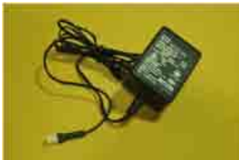
ภาพที่ 3-25 สวิตชิ่งอะแดปเตอร์ ขนาดแรงดันไฟตรง 5 โวลต์ 1.2แอมป์
