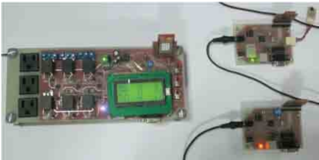
ภาพที่ 5-15 ทดสอบการร้องขอข้อมูลของแผงปลั๊กจากส่วนตรวจวัดย่อย
