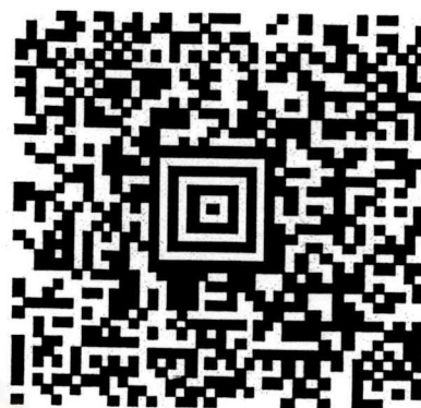
(ข) รูปแสดงลักษณะทางกายภาพของ แท่งรหัส 2 มิติแอสเทค แบบความกว้าง 42 X 42
