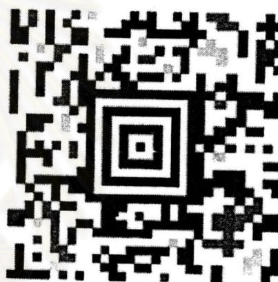
(ง) รูปแสดงลักษณะทางกายภาพของ แท่งรหัส 2 มิติแอสเทค แบบสัรหัส 1
