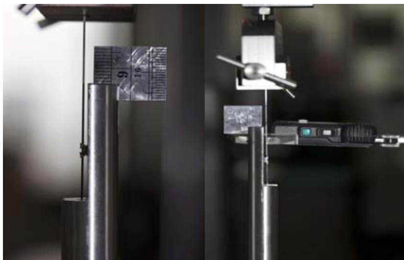
รูปที่ 16 การจัดตำแหน่งของลวดในแนวหน้า-หลัง(ซ้าย) การวัดระยะห่างด้วยเวอร์เนียคาลิเปอร์(ขวา)
