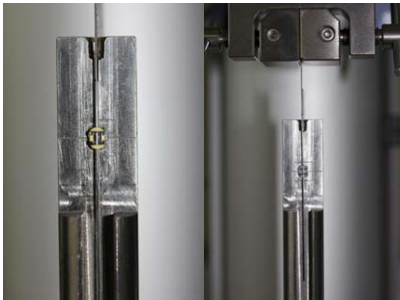
รูปที่ 15 การนำลวดใส่ในร่องของแบร์ริกเก็ต (ซ้าย)การยึดลวดเข้ากับส่วนครอสเฮด(cross head) (ขวา)
