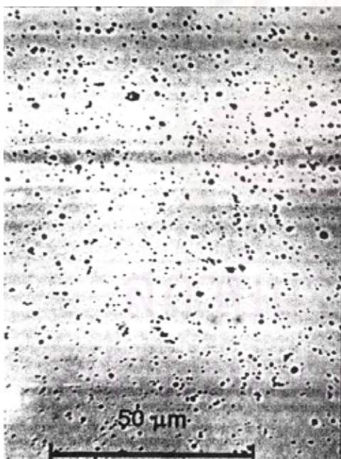
ภาพที่ 4 Light micrograph ของ MP 3 (Simplese ® ) ที่ความเข้มข้น 1.5% ในน้ำ แสดงให้เห็น ขนาด รูปร่าง และการกระจายของอนุภาค ที่มา: Singer and Dunn (1990)
