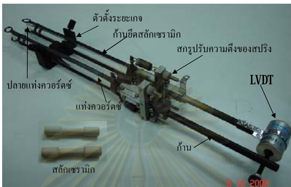
รูปที่ 3.2 extensometer วัดระยะเสียดรูปบริเวณความยาวเกจของชิ้นงานทดสอบความล้าที่อุณหภูมิสูง
