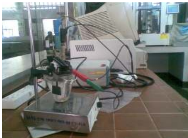
รูปที่ 3.6 การวัดค่าการกัดกร่อนของชิ้นงาน [32]
