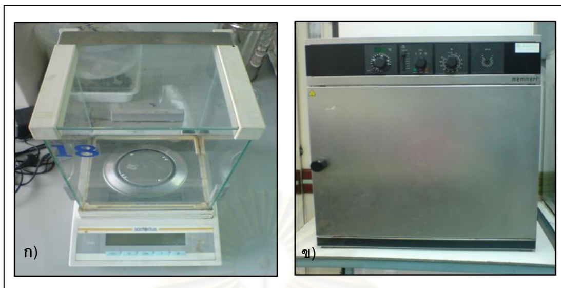
รูปที่ 7 ก) เครื่องชั่งละเอียด 4 ตำแหน่งพิกัด 220 กรัม ข) ตู้อบความร้อน (hot air oven)
