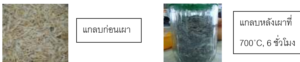
ภาพที่ 4.3 ลักษณะแกลบก่อนเผา และแกลบหลังเผา
