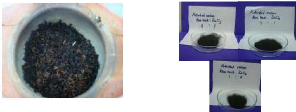
ภาพที่ 4.2 ลักษณะแกลบที่ผ่านการกระตุ้นด้วย ZnCl_2 และ ถ่านกัมมันต์ที่ได้
