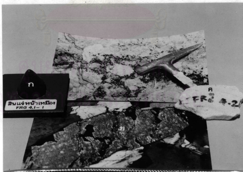
รูปที่ 3.12 ก) ผลการเพารูปกรวยของหินแร่หน้าเหมืองตามรูปที่ 3.8, ข) ภาพแร่ตัดบาง ของแร่ทัวร์มาลีน (T1), 25X, ภายใต้ X-Nicol, ค) หินตัดเรียบผ่านการกัดผิว (Stained Rock Slab)
