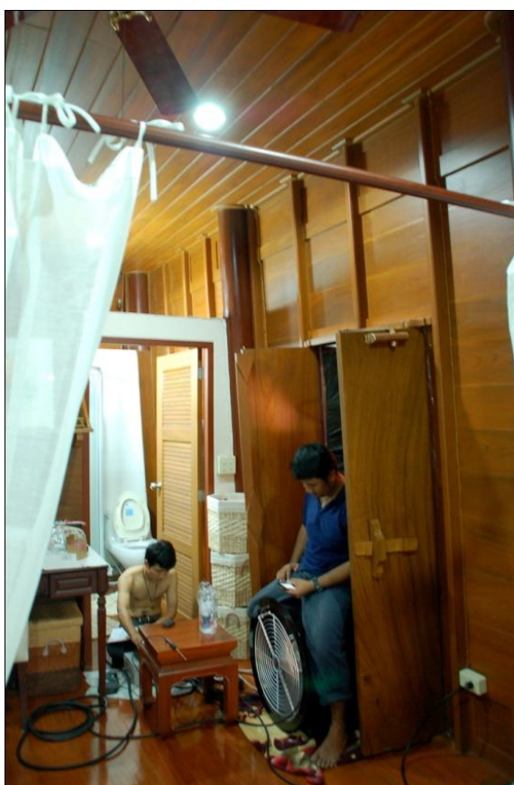
ภาพที่ 4.14 ภาพแสดงการทดลองวัดค่าการรั่วซึมอากาศ โดยวิธีการ Pressurization และ Depressurization ในอาคารกรณีศึกษา “เรือนไทยหมู่ ของ ดร.ภิญโญ สุวรรณคีรี”
