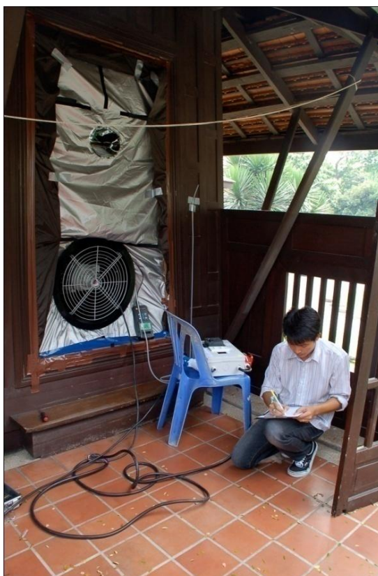
ภาพที่ 4.7 ภาพแสดงการทดลองวัดค่าการรั่วซึมอากาศ โดยวิธีการ Pressurization และ Depressurization ในอาคารกรณีศึกษา “เรือนไทยจุฬา”
