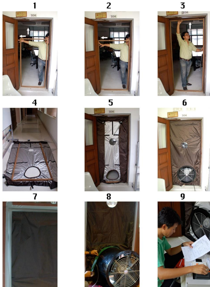
ขั้นตอนการติดตั้ง Blower Door
