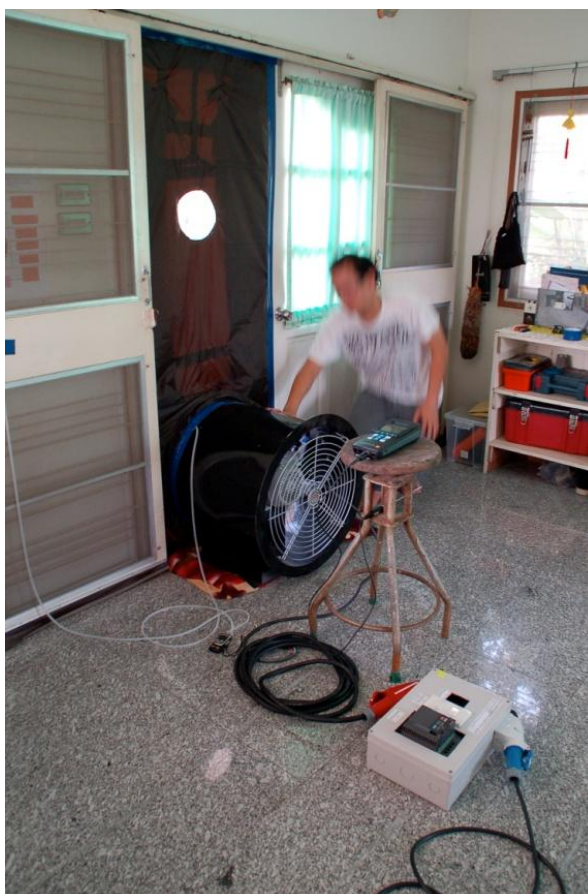
ภาพที่ 4.27 ภาพแสดงการทดลองวัดค่าการรั่วซึมอากาศ โดยวิธีการ Pressurization และ Depressurization ในอาคารกรณีศึกษา “บ้านร่วมสมัย ของ คุณกัทยาพี กามีฮา”
