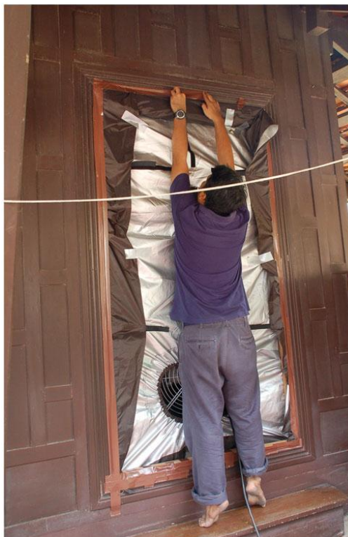
ภาพที่ 4.6 ภาพแสดงการติดตั้ง Blower Door และอุปกรณ์ในการวัดค่าการรั่วซึมอากาศ ในอาคารกรณีศึกษา “เรือนไทยจุฬา”
