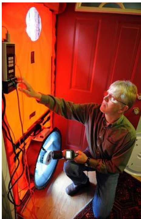
ภาพที่ 2.8 แสดงวิธีการวัดการรั่วซึมของอากาศโดยวิธีการ Fan Pressurization Method ตามมาตรฐาน ASTM E779-0 (Infrared diagnostic, 2011: online)
