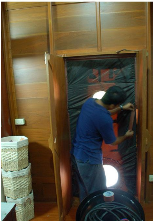
ภาพที่ 4.13 ภาพแสดง การติดตั้ง Blower Doorและอุปกรณ์ในการวัดค่าการรั่วซึมอากาศ ในอาคารกรณีศึกษา “เรือนไทยหมู่” ของ ดร.ภิญโญ สุวรรณคีรี”
