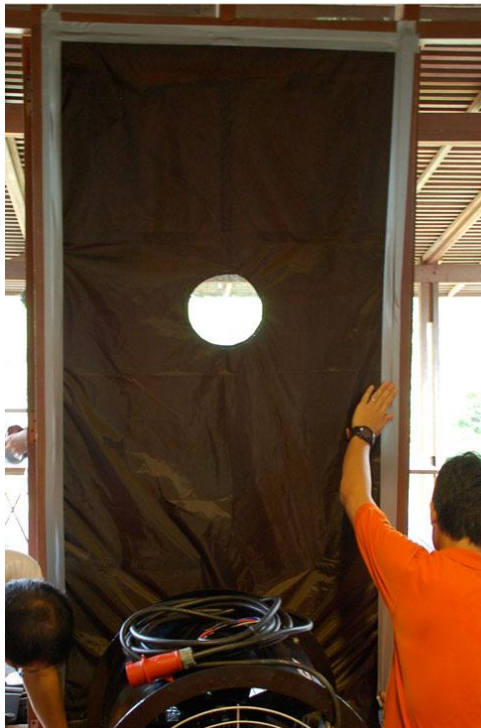
ภาพที่ 4.20 ภาพแสดงการติดตั้ง Blower Door และอุปกรณ์ในการวัดค่าการรั่วซึมอากาศ ในอาคารกรณีศึกษา “เรือนไทยประยุกต์ ของ สถาบันอาศรมศิลป์”
