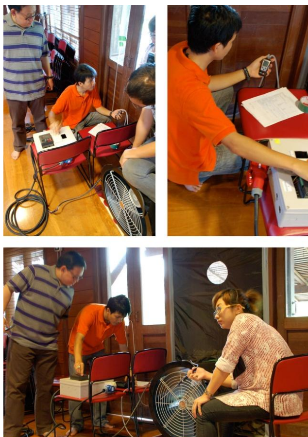
ภาพที่ 4.21 ภาพแสดงการทดลองวัดค่าการรั่วซึมอากาศ โดยวิธีการ Pressurization และ Depressurization ในอาคารกรณีศึกษา “เรือนไทยประยุกต์ ของ สถาบันอาศรมศิลป์”
