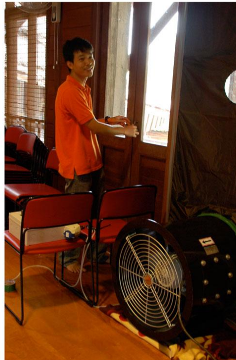
ภาพที่ 4.20 ภาพแสดงการติดตั้ง Blower Door และอุปกรณ์ในการวัดค่าการรั่วซึมอากาศ ในอาคารกรณีศึกษา “เรือนไทยประยุกต์ ของ สถาบันอาศรมศิลป์”
