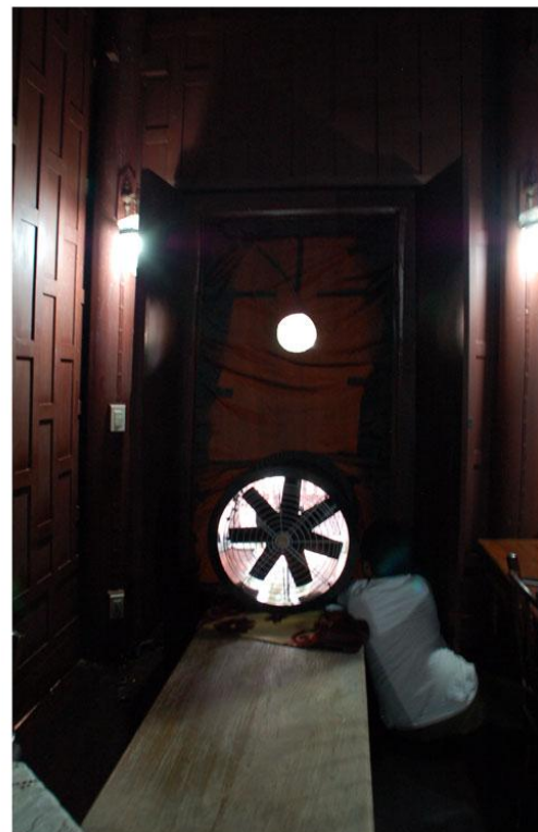
ภาพที่ 4.6 ภาพแสดงการติดตั้ง Blower Door และอุปกรณ์ในการวัดค่าการรั่วซึมอากาศ ในอาคารกรณีศึกษา “เรือนไทยจุฬา”
