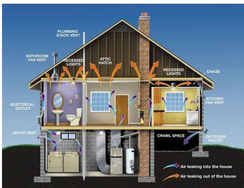
ภาพที่ 2.1 แสดงลักษณะการเกิด Infiltration และ Exfiltration ผ่านส่วนประกอบต่างๆของอาคาร (Chicagoheating-repair, 2011: online)
