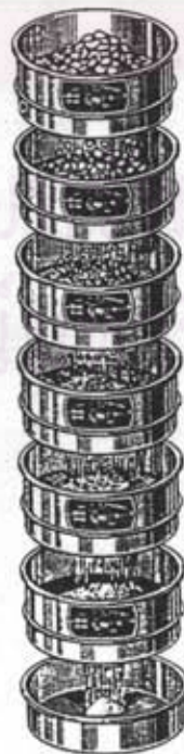
รูปที่ ข.1 การวิเคราะห์ขนาดด้วยตะแกรงลิ้น (66)
