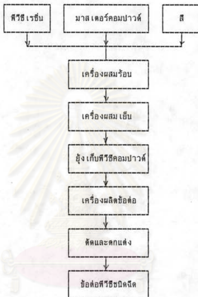
รูปที่ 2 กระบวนการผลิตข้อต่อพีวีซีชนิดฉีดจาก เครื่อง
