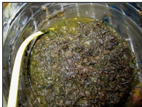
ภาพที่ 4.9 ลักษณะมูลฝอยสังเคราะห์และปุ๋ยหมักหลังจบการทดลองของถังปฏิกริยา U (ภาพ ก) และถังปฏิกริยา UL (ภาพ ข)
