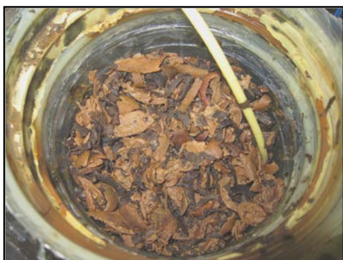
ภาพที่ 4.8 ปุ๋ยหมักทางด้านบนหลังจากจบการทดลองของถังปฏิกริยา U (ภาพ ก) และถังปฏิกริยา UL (ภาพ ข)
