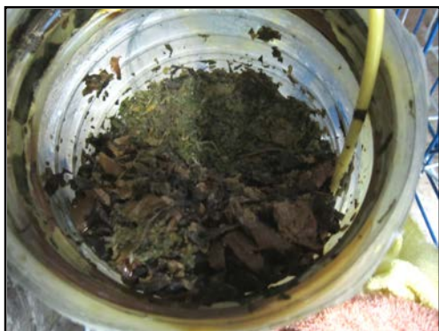
ภาพที่ 4.9 ลักษณะมูลฝอยสังเคราะห์และปุ๋ยหมักหลังจบการทดลองของถังปฏิกริยา U (ภาพ ก) และถังปฏิกริยา UL (ภาพ ข)
