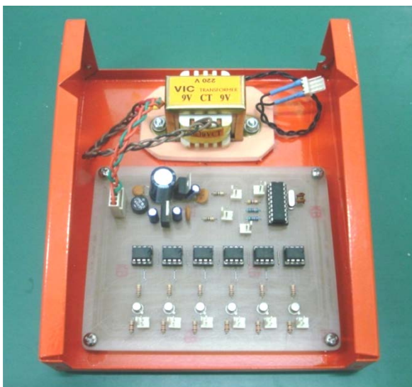
รูปที่ 3.14 ภายในกล่องของเครื่องกำเนิดการสั่น
