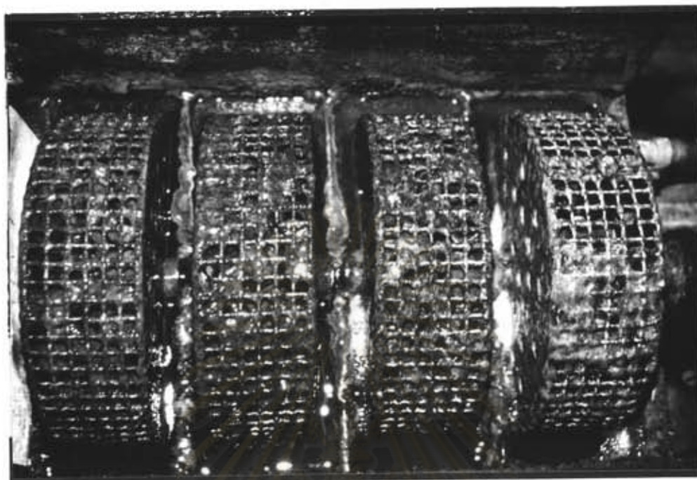
รูปที่ 5-9 ลักษณะของฟิล์มจุลชีพในการทดลองที่ 8
