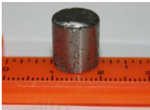
ภาพที่ 3.15 เม็ดซีเรียมเซอรโคเนียมหลังจากทำการเผาผลาญที่อุณหภูมิ 1,200 °C
