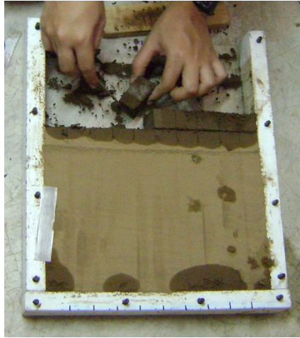
รูปที่ 4.12 การตัดดินเพื่อนำไปหาค่าความชื้นโดยปริมาตร
