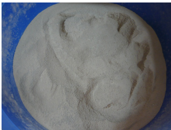
รูปที่ 4.9 ตัวอย่างดินที่ผ่านการบดและร่อนผ่านตระแกรงร่อนขนาด 2 มิลลิเมตร
