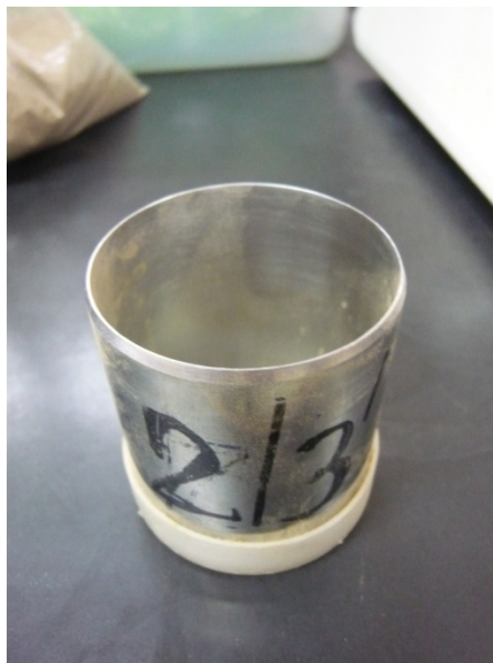
รูปที่ 4.3 แสดงการทดลองหาความหนาแน่นของดินรวม ( \rho_b )
